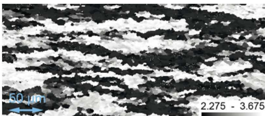
Fig. 93. Carte du facteur de Taylor de l'échantillon déformé à \epsilon = 0,92 et 0,52 T_f [Primig, 2011]
