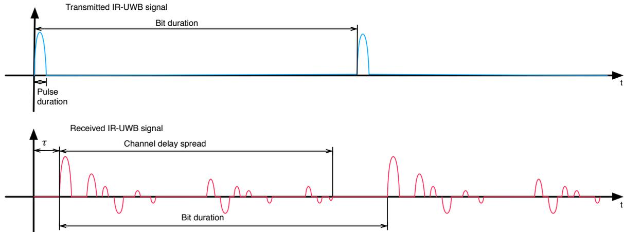
Figure 43: Etallement des échos sur l'IR-UWB
