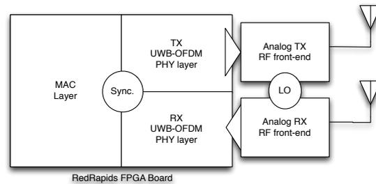
Figure 47: Schema bloc du démonstrateur
