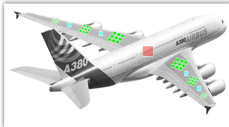
FIGURE 10 : SYSTEME SANS FIL DE MESURE D'UN PROFIL DE PRESSION AUTOUR D'UN AVION ET DE LA REPONSE MECANIQUE D'UN SATELLITE
