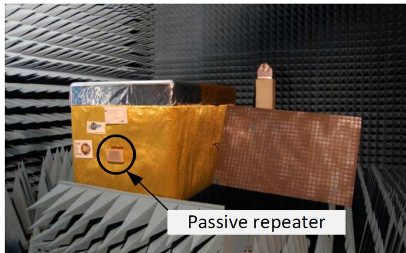
FIGURE 31 : MAQUETTE UTILISEE POUR LA VALIDATION : LAAS-SAT
