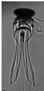
Figure III.69 : Représentation du transfert de matière entre une goutte de butanol et de l'eau douce et visualisation des volutes de butanol dans le sillage de la goutte
