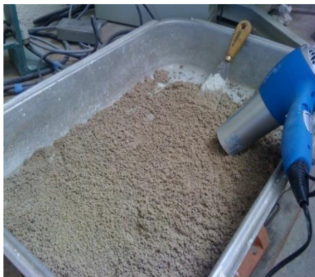
Figure II.28. Séchage de surface des granulats par un courant d'air chaud
