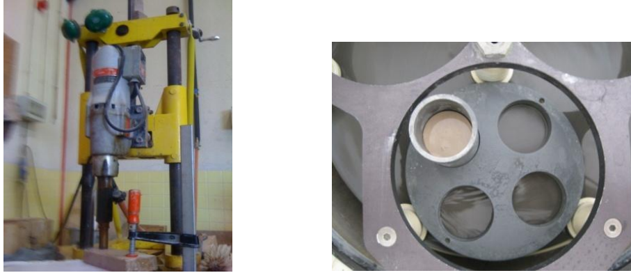
Figure II.20. Carottage d'un échantillon (à gauche); Rectification d'une pierre cylindrique (à droite)
