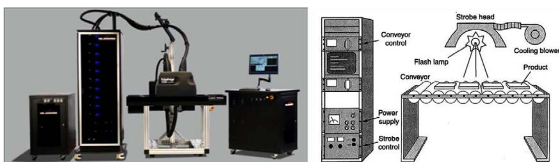
Figure 3.30 Photographie de l'équipement PulseForge 3300 utilisé pour les recuits photoniques de NPs Si (gauche) et schéma explicatif du four (West et al. 2012)
