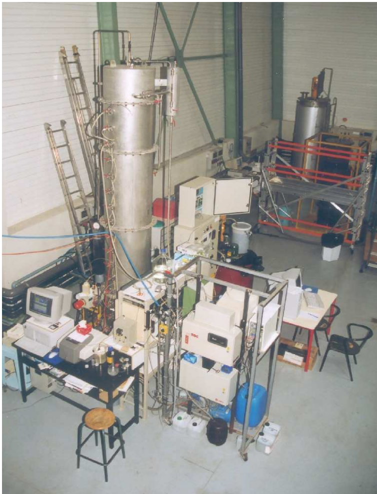
Figure 1.2: Anaerobic digester developed at the Laboratoire de Biotechnologie de l'Environnement, INRA, Narbonne, France.
