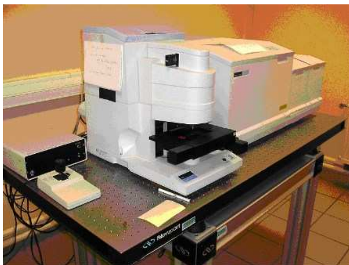
FIGURE 1.9 – Spectromètre infrarouge de Perkin-Elmer utilisé, LPMCL-équipe SOPRANO
