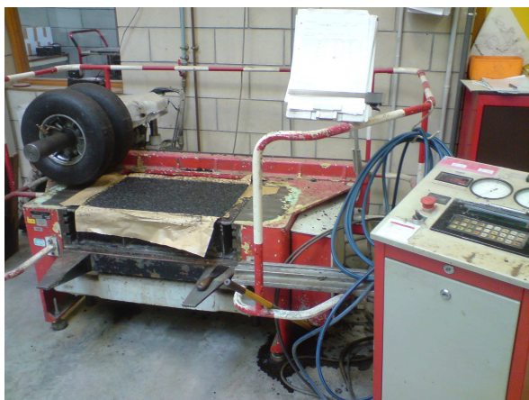
FIGURE B.1 – Banc de compactage MLPC à l'IFST-TAR Nantes
