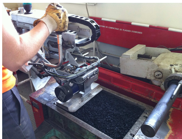
FIGURE B.2 – Banc de compactage MLPC au LRPC Angers
