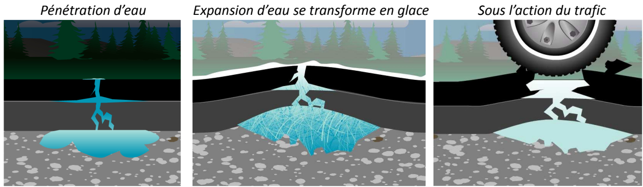
FIGURE 1.14 – Dégradation causée par action du trafic et effet de gel et de dégel
