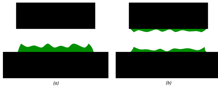
FIGURE 1.13 – Schéma d'une rupture (a) adhésive ; (b) cohésive
