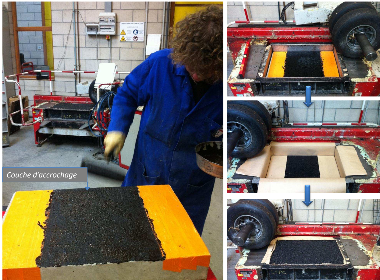
FIGURE B.9 – Étape de fabrication de l'éprouvette type II
