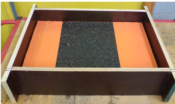
FIGURE B.6 – Coffrage de la plaque d'enrobé
