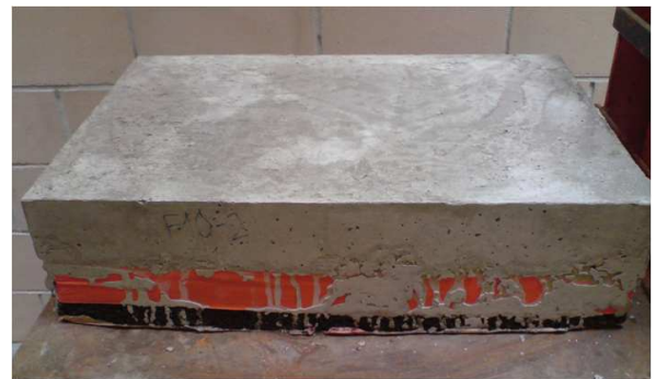
FIGURE B.7 – Plaque bicouche après décoffrage
