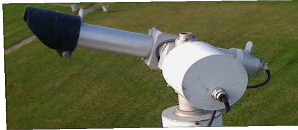
FIGURE 3.7 – Le luminancemètre utilisé pour acquérir les données de référence sur le site instrumenté de Trappes.
