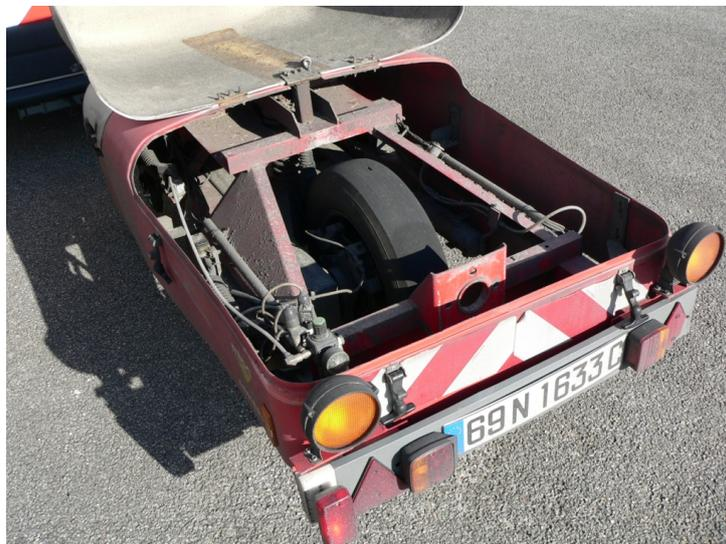
Figure 1.17 — *Remorque et roue de mesure de l'ADHERA.*
