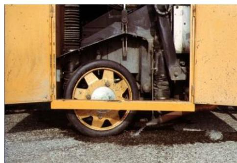
Figure 1.24 — *Appareil de mesure de frottement SCRIM.*
