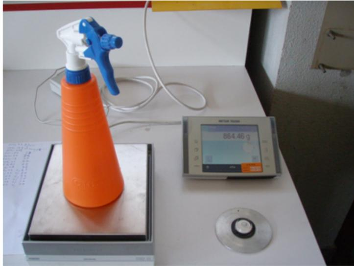
**Figure 2.12** — *Pesée du pulvérisateur avec une balance de précision.*
