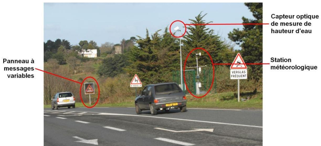
Figure 5.24 — *Système d'information dynamique en bord de voie.*
