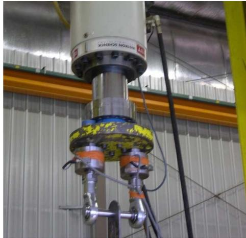
FIGURE 3.14 – Vérin Schenck équipé de capteurs de force
