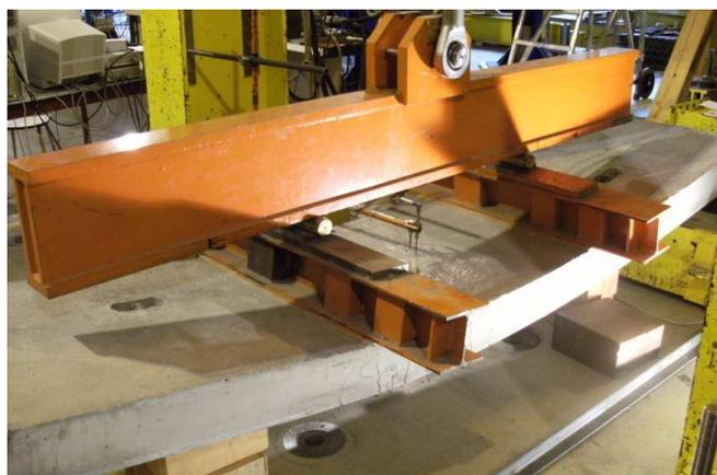
FIGURE 4.11 – Poutre en flexion à 4 points
