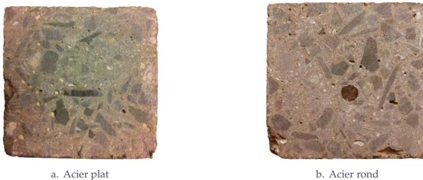
FIGURE 3.33 – L'excentrement de la barre d'acier
