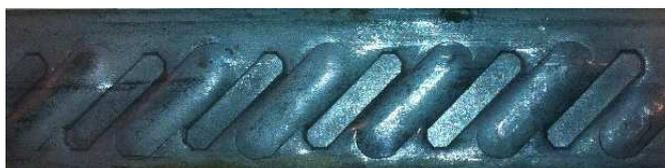
FIGURE 3.9 – Acier plat cranté artisanal de la première campagne d'essai de tirant ( $25 \times 3,5 \text{ mm}^2$ )
