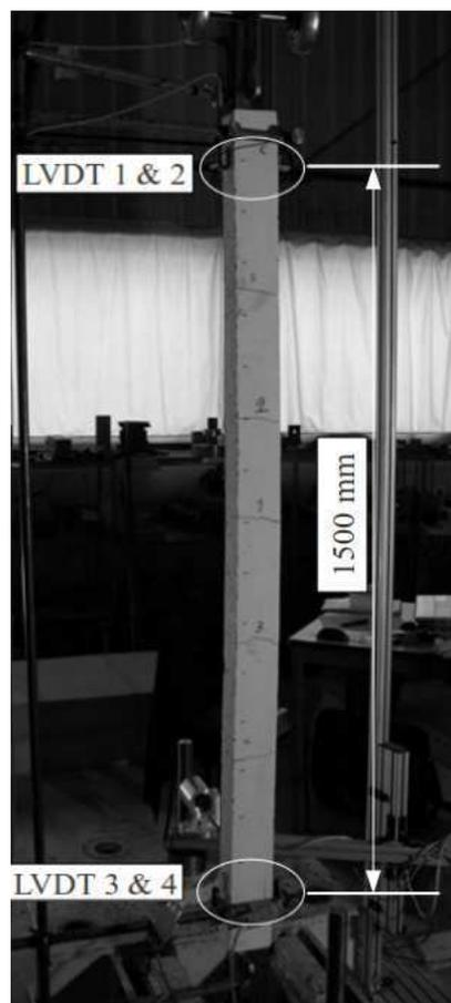
FIGURE B.1 – Essai de tirant
