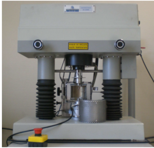
Figure 3. Métravib apparatus used for bitumen tests [EIFFAGE Travaux Publics laboratory, Corbas, France]
