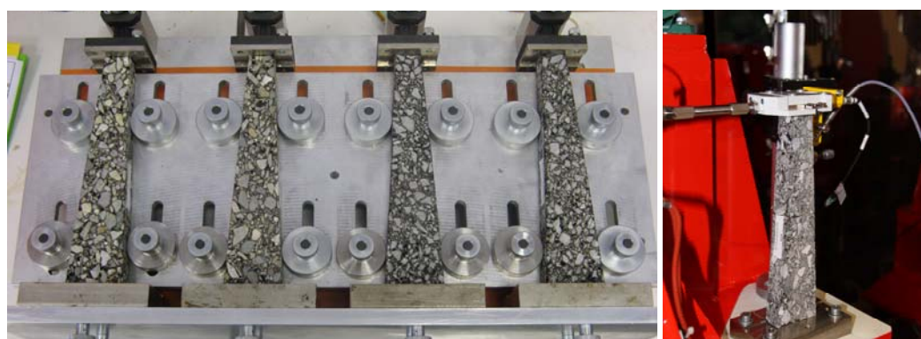
Figure 44. (gauche) banc de collage des casques sur les éprouvettes trapézoïdales ; (droite) essai de fatigue à 10°C et 25 Hz, en flexion deux points sur éprouvettes trapézoïdales (EN 12697-24 2005).
