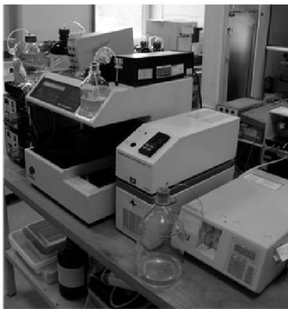
FIGURE 2.14: Chromatographie liquide haute performance couplée à un détecteur fluorimétrique
