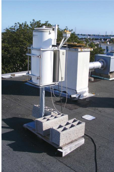
FIGURE 2.5: Pluviomètre découvrant pour la mesure de la retombée humide
