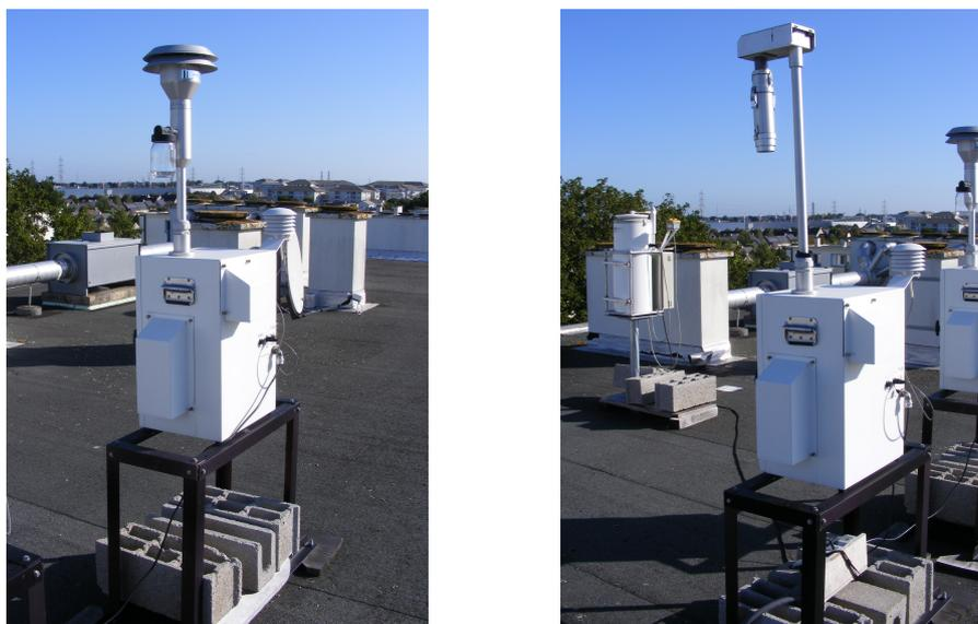
FIGURE 2.2: Partisols pour la mesure des ETM (à gauche) et des polluants organiques (à droite)
