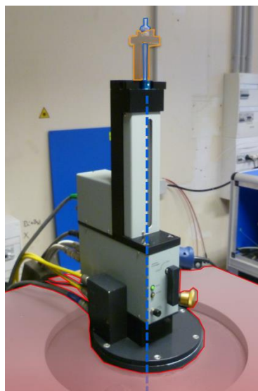
Figure A10 – Magnétomètre SQUID de marque Quantum Design (modèle MPMS-5) utilisé à l'ICMMO. Couleurs : bobine supraconductrice (rouge), canne contenant l'échantillon (bleu), bras mobile (orange).
