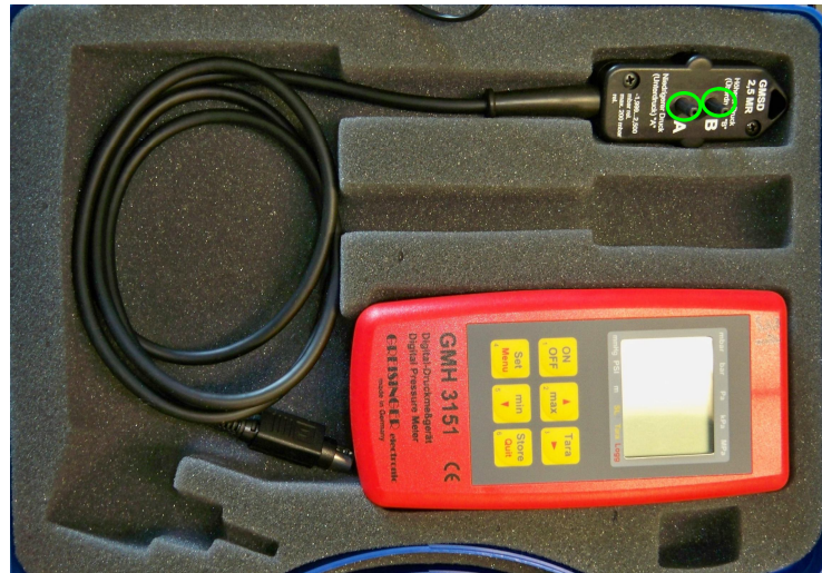
Figure 2. 17 : Capteur de pression différentielle d'air Greisinger
