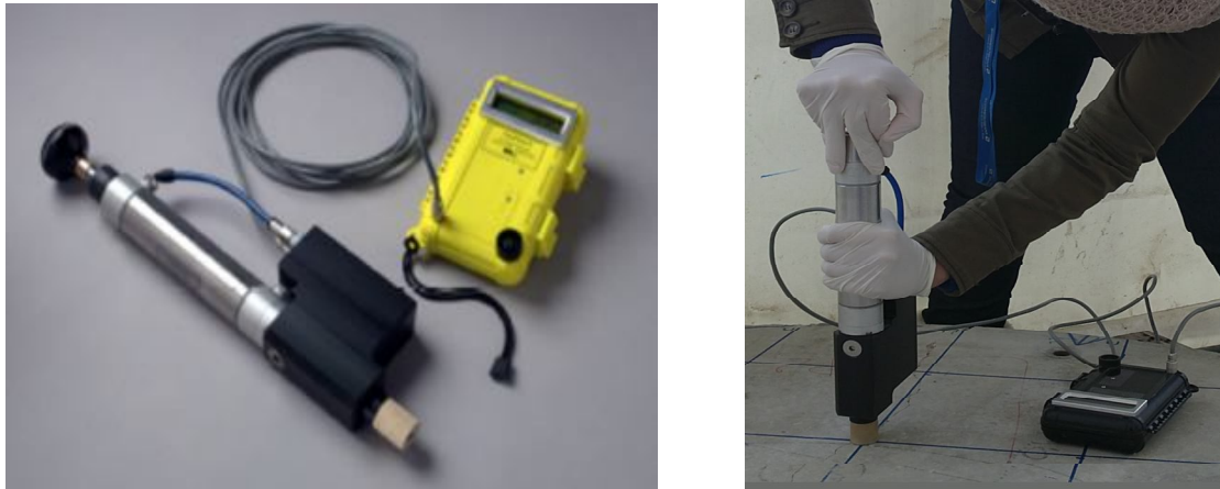
Figure 2. 31: TinyPerm, appareil de mesure de perméabilité locale
