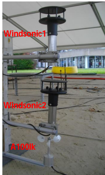
Figure 2. 29: Mesures de vitesse et direction du vent sur SCERES
