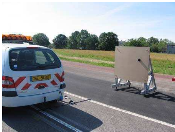
FIGURE 1.14 – Validation de la technique « Backing Board » sur la piste de référence du LCPC dans le cadre du projet européen Silence (Bérenghier, 2008).
