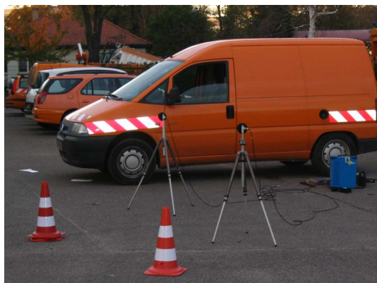
FIGURE 5.10 – Photos des configurations de mesures avec des sources réelles. (a) un haut-parleur en mouvement - (b) une voiture à l'arrêt moteur allumé - (c) un cyclomoteur de 50 cm 3 à l'arrêt moteur allumé.
