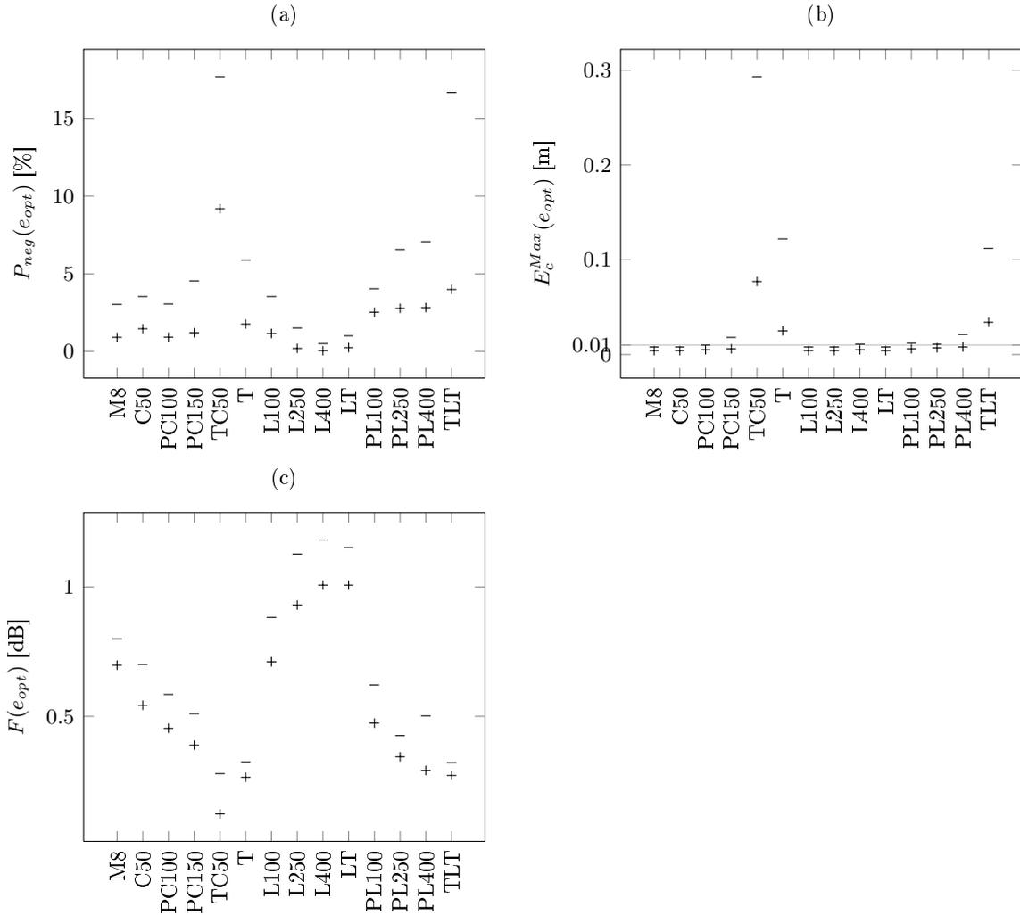
Figure 6.22: Variantes de la MÉCS afin de limiter le pourcentage  $P_{neg}(e_{opt})$  de  $|A_i(f)|^2$  négatifs. (a)  $P_{neg}(e_{opt})$  - (b)  $E_c^{Max}(e_{opt})$  - (c) Résidu. Les moyennes (+) et maxima (-) sont calculés sur 10 simulations.
