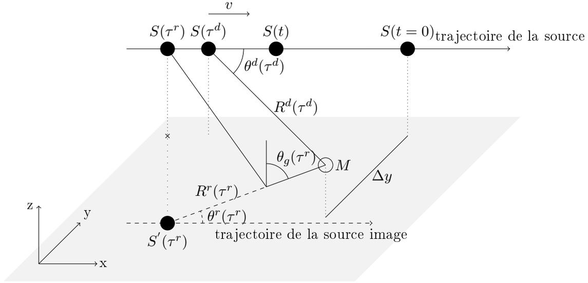
FIGURE 1.12 – Une source  $S$  et sa source image associée  $S'$  en mouvement en présence d'un récepteur  $M$  fixe.
