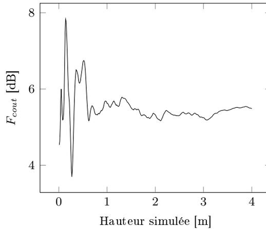
FIGURE 5.8 – Simulations numériques avec quatre sources en mouvement. Simulation 2 :  $v = 85 \text{ km.h}^{-1}$ ,  $z_S^{Sim}=0.28 \text{ m}$ ,  $z_S^{Opt}=0.27 \text{ m}$ . Hauteur optimisée en fonction de la hauteur simulée  $z_S^{Sim}$ .
