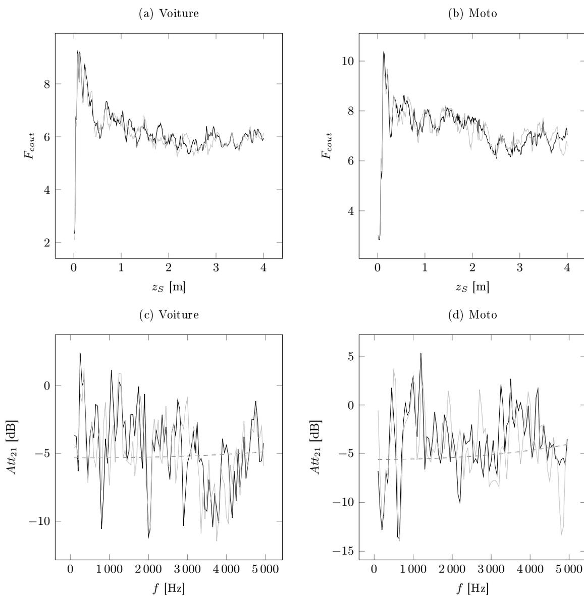
Figure 5.12: Mesure de la hauteur de source de deux véhicules immobiles et moteur allumé : voiture et cyclomoteur de  $50 \text{ cm}^3$ , deux mesures pour chaque source. Fonction coût (— ou —) : (a) voiture - (b) cyclomoteur de  $50 \text{ cm}^3$ . Spectres d'atténuation mesurés (— ou —) et optimisés (--- ou ---) : (c) voiture - (d) cyclomoteur de  $50 \text{ cm}^3$ .
