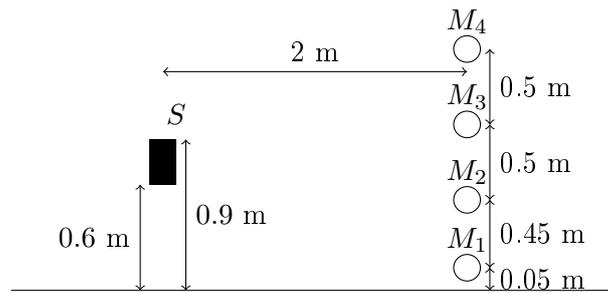
FIGURE 6.17 – Configuration simulée C3. Modélisation d'une source étendue par 50 sources ponctuelles disposées verticalement.
