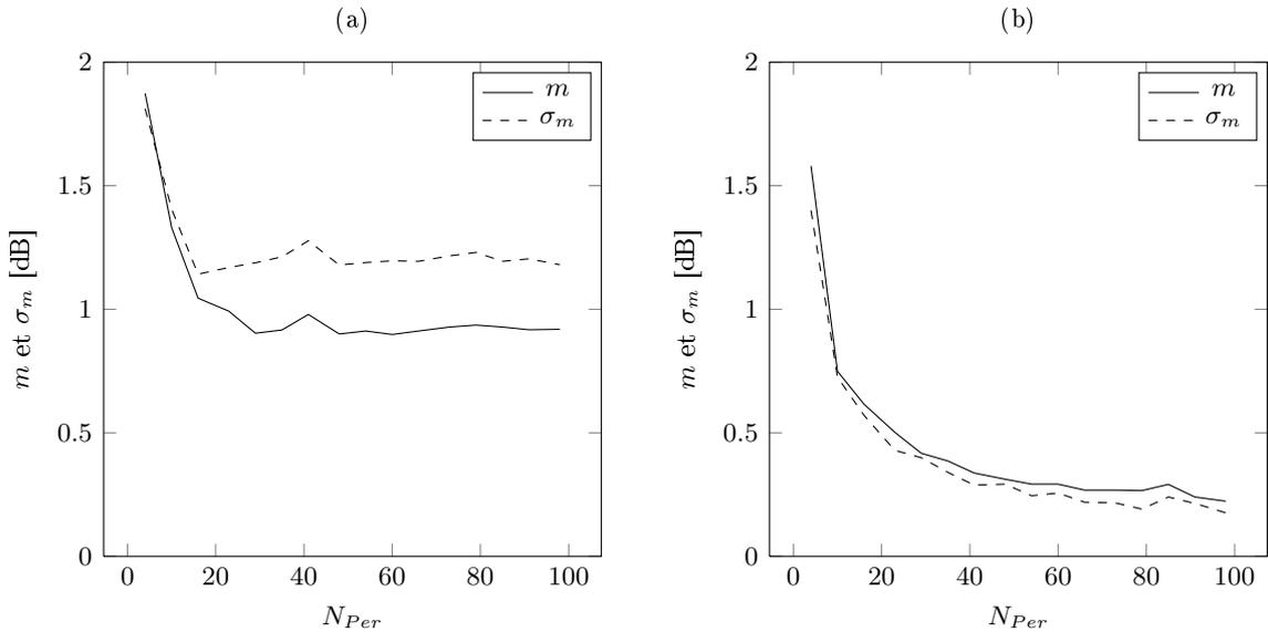
Figure 3.4: Valeur moyenne  $m$  et écart-type  $\sigma_m$  de  $\Delta DSP$ , en fonction du nombre de périodogrammes moyennés  $N_{Per}$ .  $z_S = 1$  m,  $T_I = 0.02$  s. (a)  $\Delta DSP^{Mod}$  - (b)  $\Delta DSP^{LB}$ .
