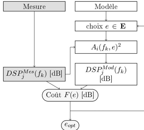
FIGURE 6.1 – Synoptique de la méthode énergétique.
