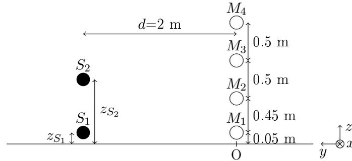
FIGURE 6.2 – Configurations simulées avec deux sources ponctuelles.
