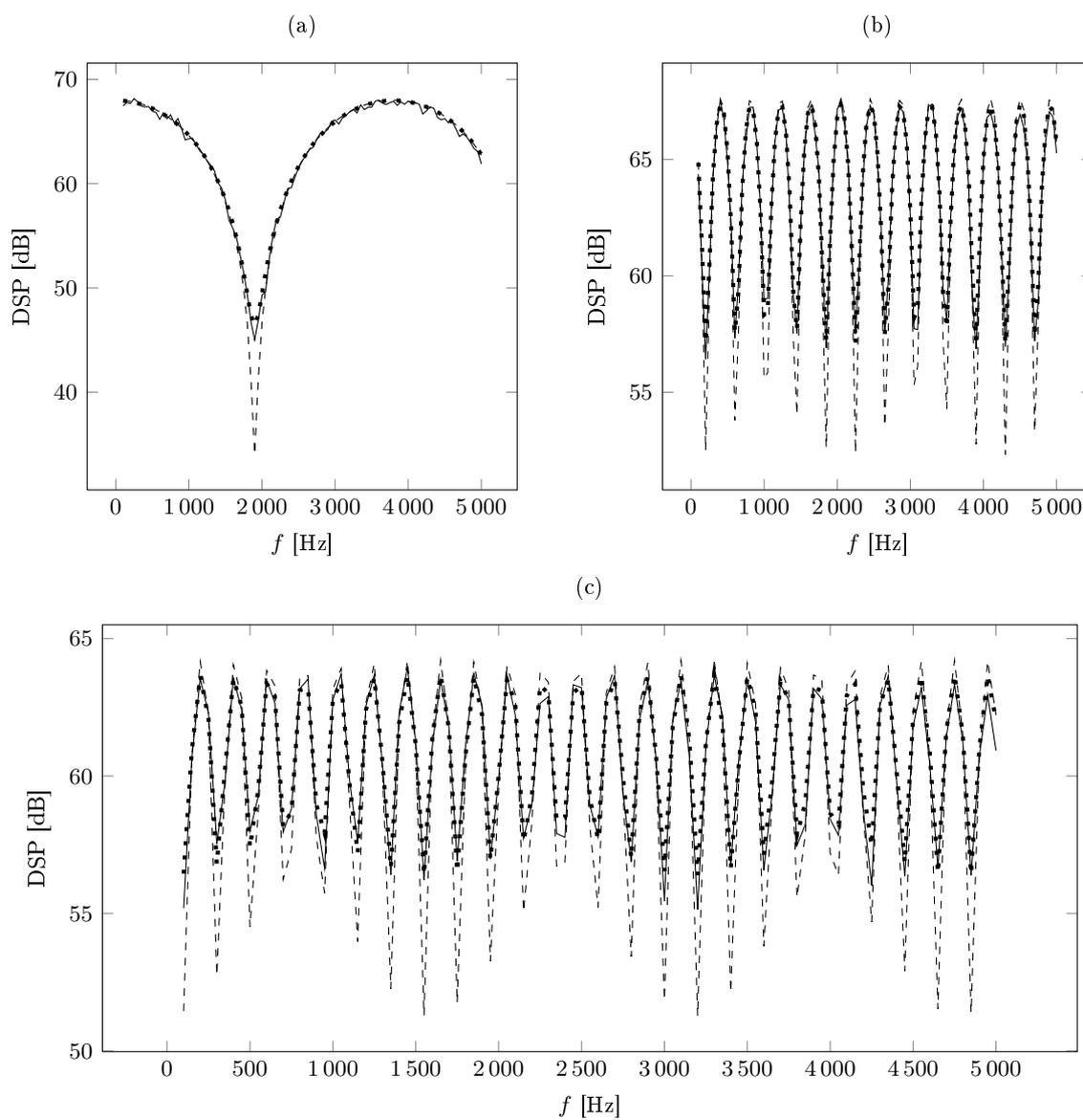
Figure 3.2: Comparaison des DSP mesurées (—), simulée avec une fonction de transfert pour une source harmonique (---), et la nouvelle formulation pour une source à large bande (····).  $N_{Per} = 48$ ,  $T_I = 0.02$  s. (a)  $z_S = 0.1$  m - (b)  $z_S = 1$  m - (c)  $z_S = 3$  m.
