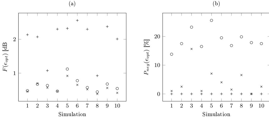
Figure 6.13: Effet du nombre  $N_{Se}$  de sources équivalentes sur le résidu de la fonction coût et sur le pourcentage de  $A_i(f)^2$  négatifs, 10 simulations. (a)  $F(e_{opt})$  - (b)  $P_{neg}(e_{opt})$ . + :  $N_{Se}=1$ , x :  $N_{Se}=2$  et o :  $N_{Se}=3$ .
