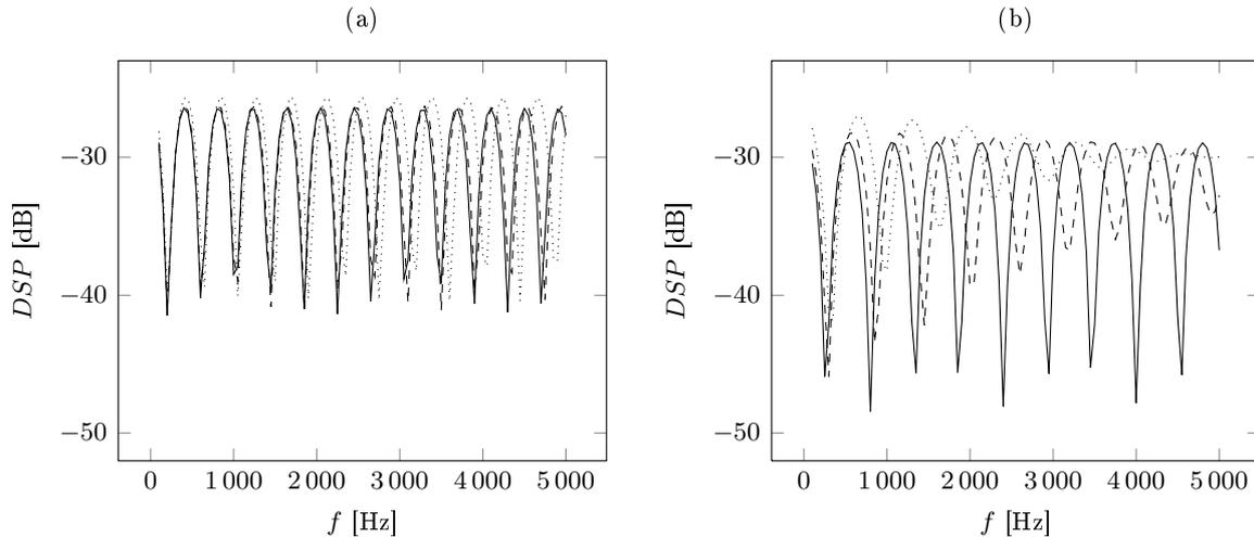
Figure 1.13: Densité spectrale de puissance simulée au microphone  $M$  pour une source  $S$  en mouvement émettant un bruit blanc, pour trois vitesses différentes :  $v = 0$  km.h<sup>-1</sup> (—),  $v = 130$  km.h<sup>-1</sup> (---),  $v = 300$  km.h<sup>-1</sup> (.....).  $f$  est comprise entre 100 Hz et 5000 Hz, avec un pas de 50 Hz.  $M(0,0,1)$ . (a)  $S(0,2,1)$  - (b)  $S(-2,2,1)$ . Calculs réalisés avec le MTSSM, développé au chapitre 2, en considérant une fenêtre de Hann.
