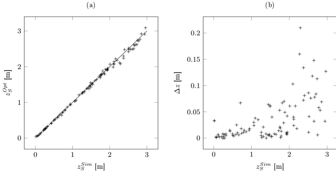
FIGURE 5.7 – Simulations numériques avec quatre sources, 100 simulations. (a) Hauteur optimisée en fonction de la hauteur simulée - (b)  $\Delta z$  en fonction de la hauteur de source simulée  $z_S^{Sim}$ .
