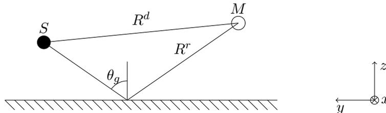
FIGURE 1.7 – Propagation multi-trajet : configuration avec une source et un microphone.
