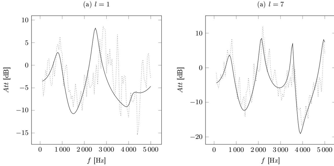
Figure 5.9: Comparaison des spectres d'atténuation pour quatre sources en mouvement : mesure (.....) et MHSD (—) à différents instants pour la mesure simulée numéro 2.  $v = 85 \text{ km.h}^{-1}$ ,  $z_S^{Sim} = 0.28 \text{ m}$ ,  $z_S^{Opt} = 0.27 \text{ m}$ . (a)  $l = 1$  - (b)  $l = 7$ .
