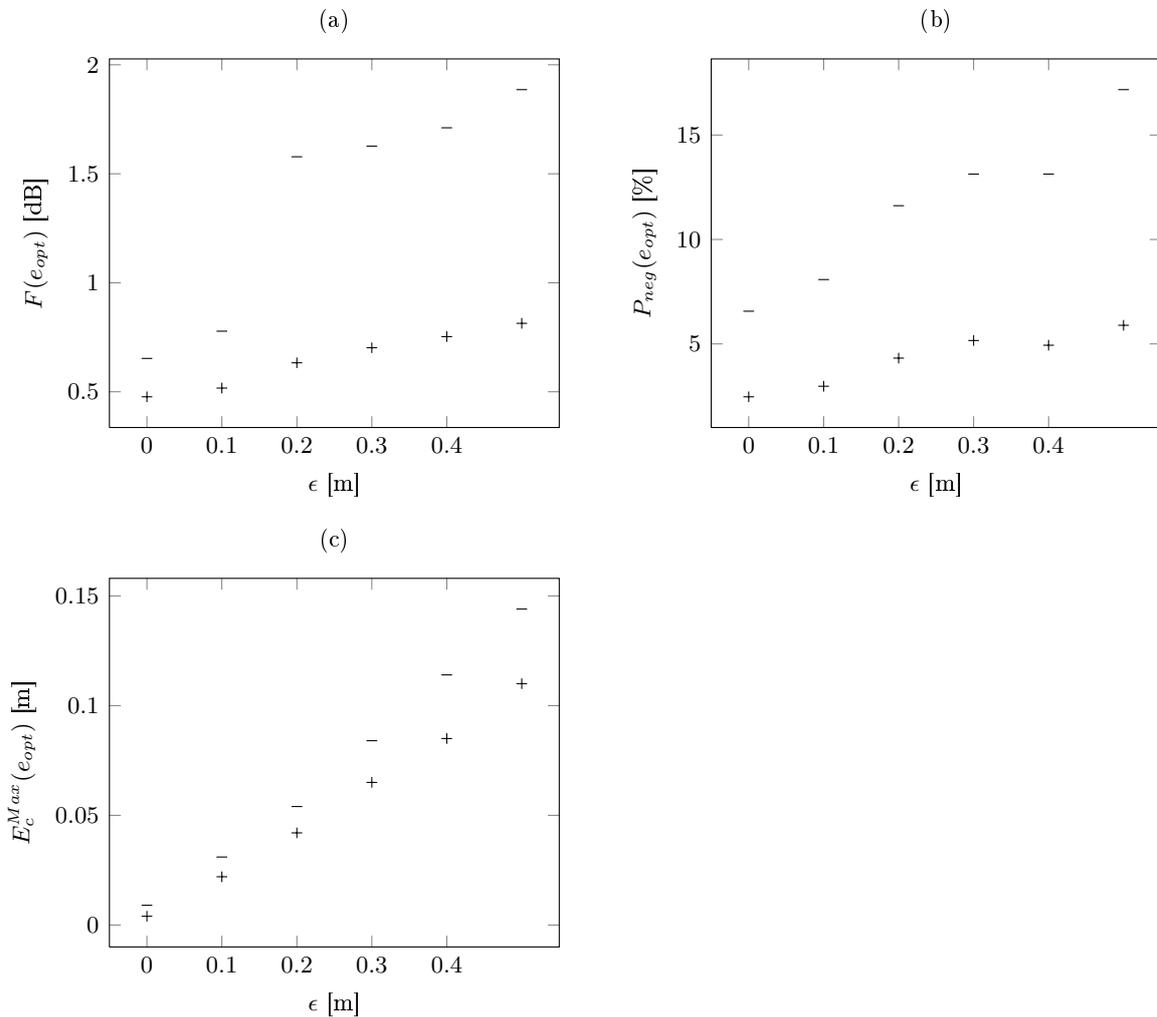
Figure 6.12: Influence de l'incertitude sur la distance  $d$ . Valeurs moyennes (+) et maximales (-) sur 9 simulations : (a)  $F(e_{opt})$  - (b)  $P_{neg}(e_{opt})$  - (c)  $E_c^{Max}(e_{opt})$ .
