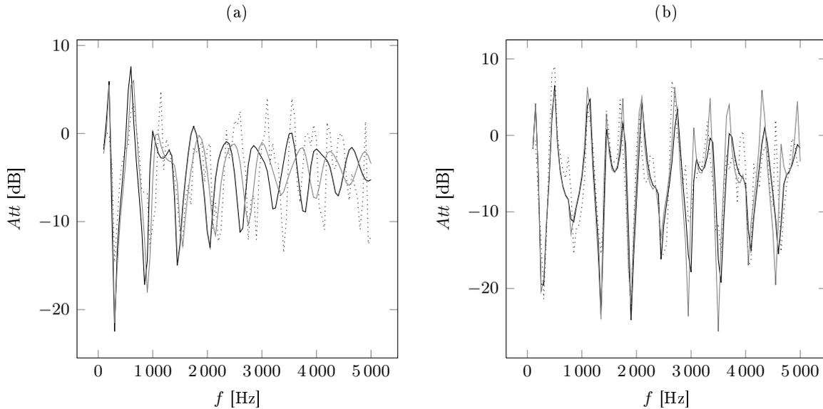
Figure 5.6: Comparaison des spectres d'atténuation pour une source en mouvement : mesure (.....), MHSB (—) et MHSM (---) à différents instants pour la mesure simulée numéro 4.  $v = 111 \text{ km.h}^{-1}$ ,  $z_S^{Sim} = 1.32 \text{ m}$ ,  $z_S^{Opt} = 1.36 \text{ m}$ . (a)  $l = 1$  - (b)  $l = 7$ .
