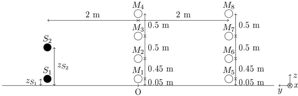
FIGURE 6.20 – Configurations simulées avec deux sources ponctuelles.
