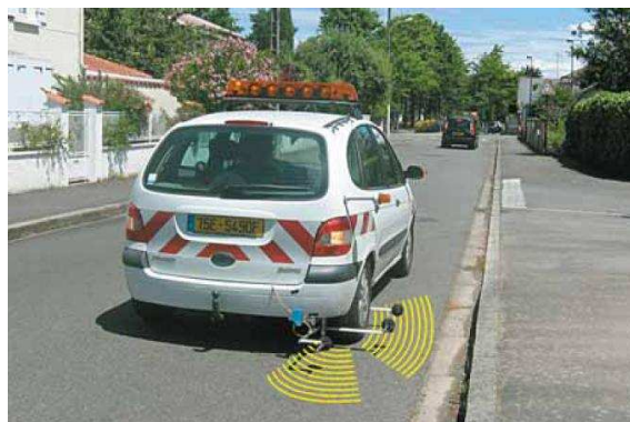
FIGURE 1.15 – Photo du Sonoroute, véhicule équipé pour la mesure du bruit de roulement en continu (Anfosso-Lédée et coll., 2008).
