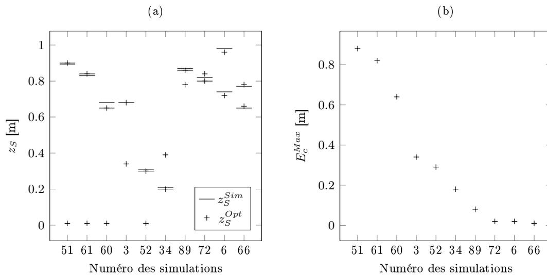
Figure 6.5: Les 10 simulations pour lesquelles l'écart entre les hauteurs de sources simulées et optimisées est le plus important, classés par  $E_c^{Max}$  décroissant. (a) Hauteurs de sources simulées (—) et optimisées (+), 2 hauteurs de sources simulées et deux hauteurs de sources optimisées pour chaque simulation (en abscisse) - (b)  $E_c^{Max}$ .
