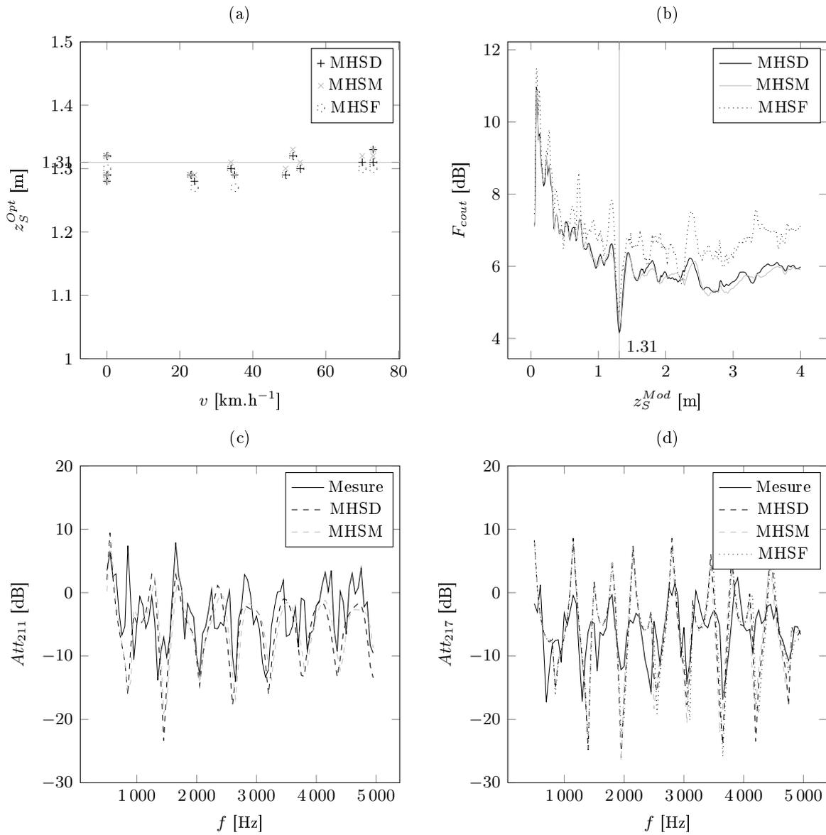
Figure 5.11: Mesures sur un haut-parleur en mouvement. (a) Hauteur de source optimisée en fonction de la vitesse, ensemble des mesures. Mesure 23 ( $v = 73$  km.h<sup>-1</sup>) : (b) Fonction coût - (c) Comparaison des spectres mesurés et modélisés,  $l = 1$  (source avant CPA) - (d) Idem avec  $l = 7$  (source localisée au CPA).
