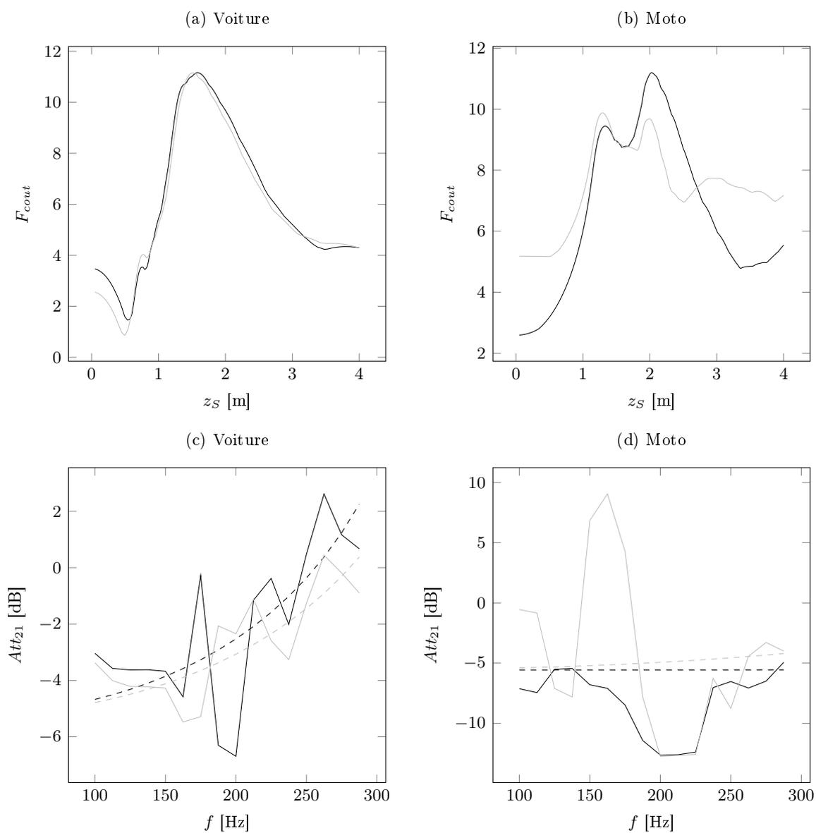
Figure 5.13: Estimation de la hauteur de source de deux véhicules immobiles et moteur allumé par la MHSF : voiture et cyclomoteur de  $50 \text{ cm}^3$ , deux mesures pour chaque source. Réduction de la plage fréquentielle d'analyse à  $[100,300]$  Hz. Fonction coût (— ou —) : (a) voiture - (b) cyclomoteur de  $50 \text{ cm}^3$ . Spectres d'atténuation mesurés (— ou —) et optimisés (--- ou ---) : (c) voiture - (d) cyclomoteur de  $50 \text{ cm}^3$ .
