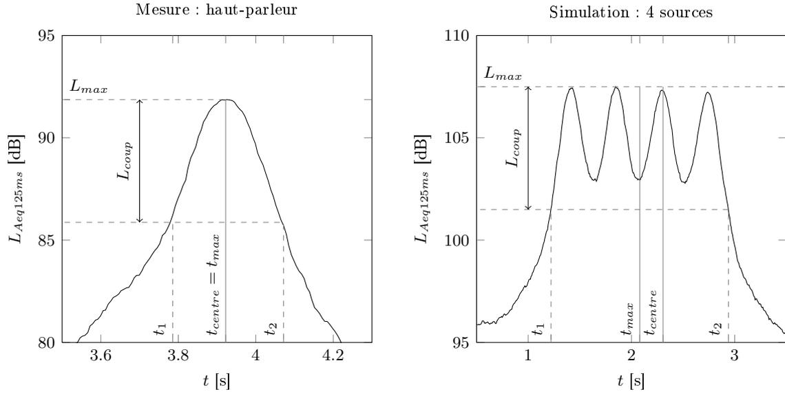
FIGURE 5.2 – Illustration du calcul de  $t_{centre}$ , à partir d’une signature au passage exprimée en  $L_{Aeq125ms}$ , calculé avec un fort taux de recouvrement ( $\approx 95\%$ ). (a) Mesure avec un haut-parleur en mouvement,  $v = 73 \text{ km.h}^{-1}$  - (b) Simulation numérique avec quatre sources en mouvement,  $v = 89 \text{ km.h}^{-1}$ .
