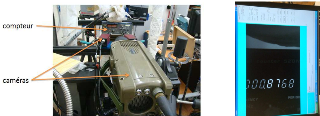
Figure 3.36 Dispositif pour contrôler le fonctionnement de l'acquisition
