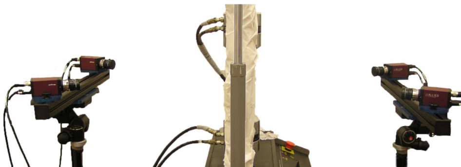
Figure 3.4 Positionnement des bancs de stéréo-corrélation
