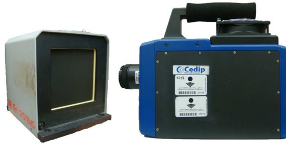
Figure 3.7 Dispositifs infrarouges (corps noir et caméra IR)
