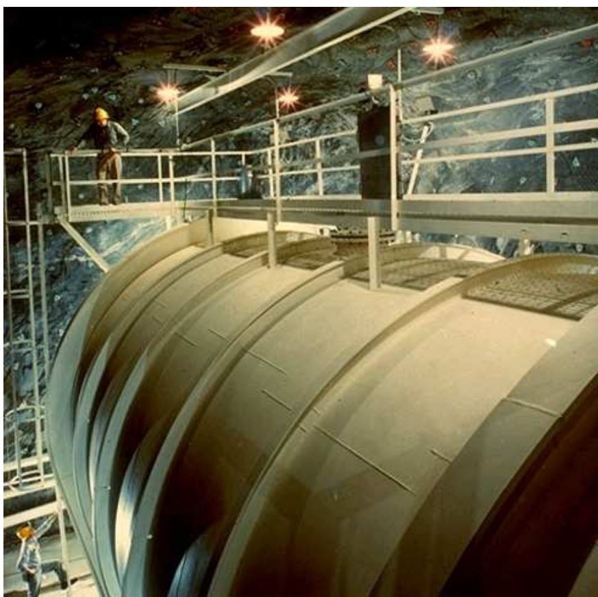
Figure A.2: Le détecteur à base de chlore dans le mine d'Homestake.
