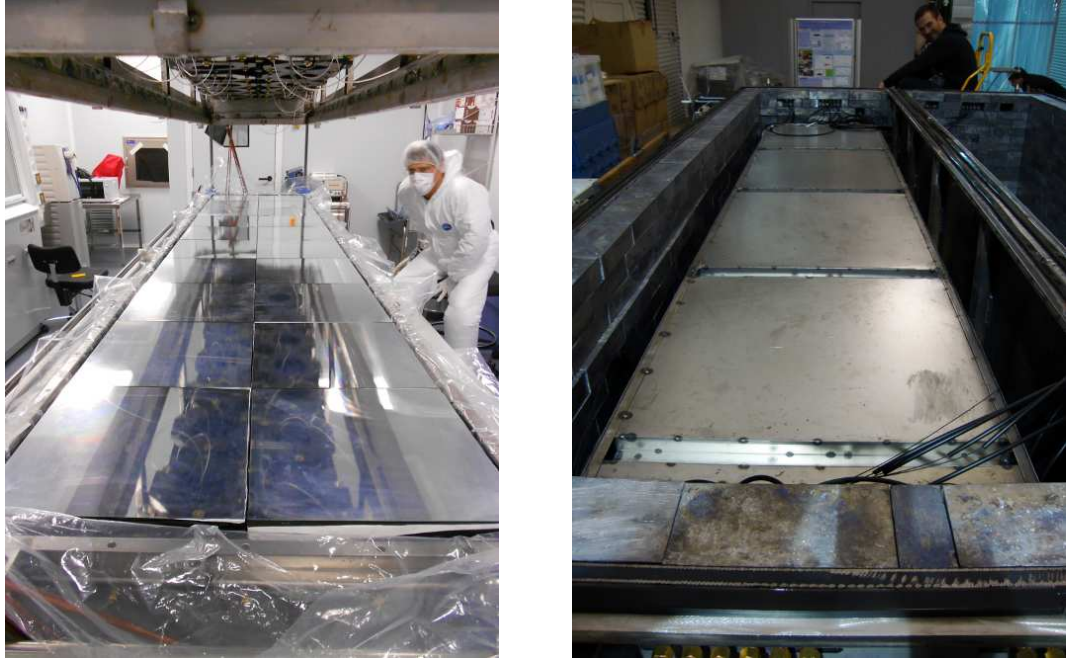
Figure 2.19: Montage et installation de BiPo 3 au Laboratoire Souterrain de Canfranc ; à gauche les modules optique de la partie basse d'un module sont en phase d'alignement en salle propre ; à droite le module fermé dans la cuve en fer avec le blindage de plomb.
