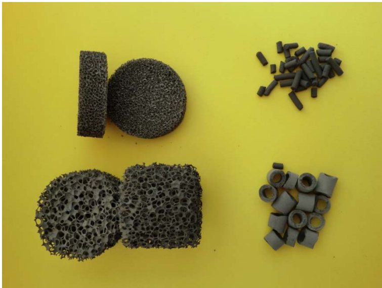
Figure 2. Différentes formes, mousses alvéolaires, extrudés et anneaux, de carbure de silicium synthétisé par la méthode de synthèse à mémoire de forme (SICAT).
