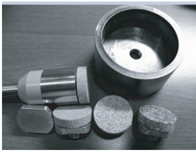
(a) Préparation des échantillon du pull-off test
