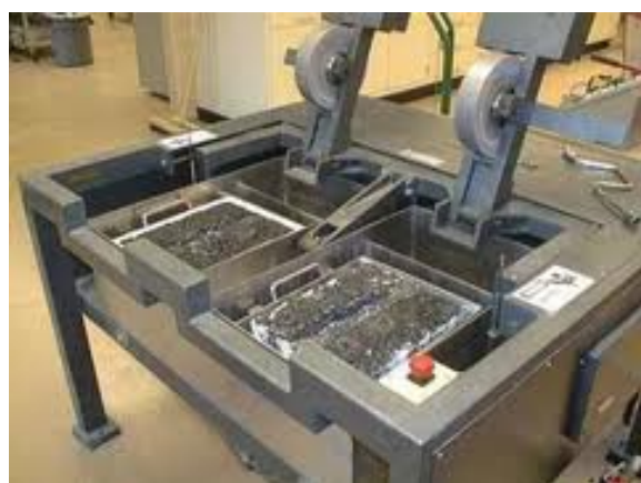
(a) Dispositif du test d'orniérage Hamburg
