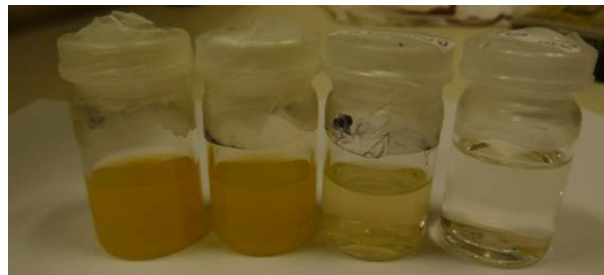
Figure 5.8 – Échantillons de BFO de différentes concentrations obtenues après dilution. Les concentrations relatives pour chaque échantillon sont (de gauche à droite) : 1 ; 0,8 ; 0,2 ; 0,02.
