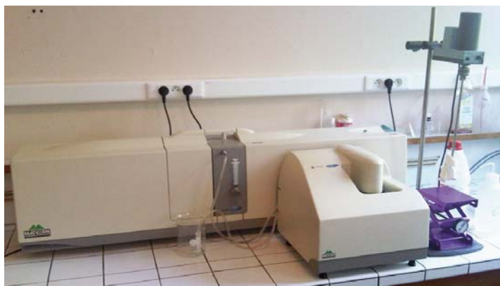
Figure N: Granulomètre laser de type Malvern Mastersizer 2000 (Université Paris Sud)
