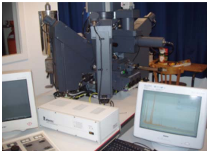
Figure D : Microsonde électronique de Castaing (IPGP, Univ. Pierre et Marie Curie) et dispositif interne
