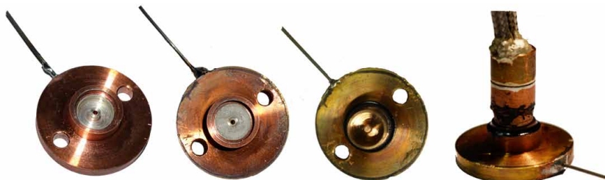
FIGURE 2.10 – Photos de la cellule à différentes étapes du montage jusqu'à la cellule complète. De gauche à droite : argenture sur le fond de la cellule puis on dépose du fritté d'argent avant de coller le diaphragme et les parties supérieures.
