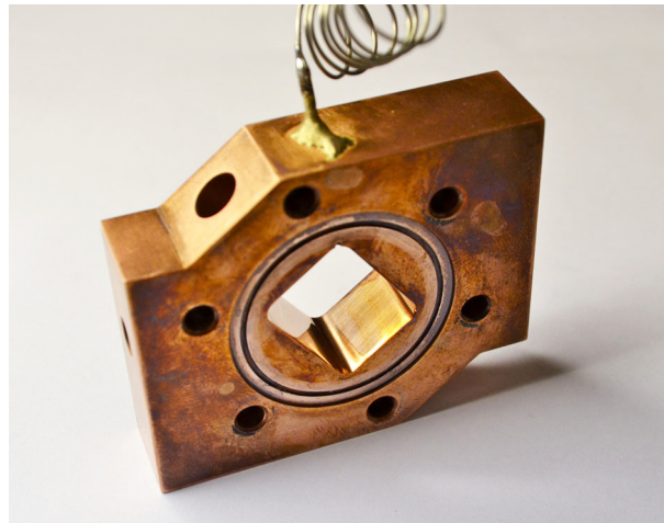
FIGURE 3.22 – Future cellule pour la croissance de cristaux parfaits dans laquelle les transducteurs sont situés à l'extérieur de la cavité acoustique couplés à de fines membranes. La cavité ne possède pas d'aspérité visible, de plus elle est finement polie pour permettre une croissance la plus régulière possible.
