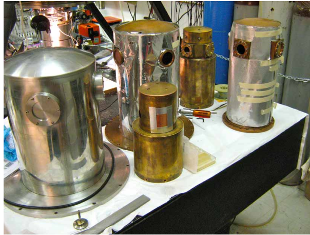
FIGURE 2.3 – Photo des différents boucliers thermiques qui s'imbriquent les uns dans les autres. Chacun possède deux paires de fenêtres avec des filtres.
