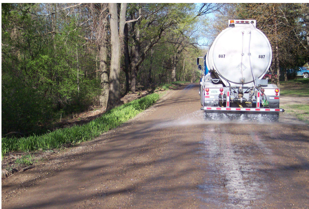
FIGURE 3.1 – Photographie d’un camion citerne destiné à déverser une solution de chlorure de calcium sur les routes sujettes à l’instabilité de tôle ondulée. Ce traitement permet d’avoir une piste plus cohésive qui développera des rides plus lentement (source : Google Image).
