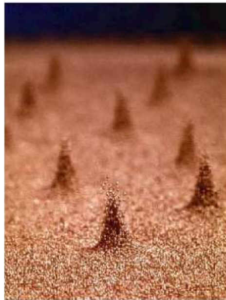
FIGURE 3 – Structure localisée résultant à l'interaction non-linéaire des différents modes instables. D'après Umbanhowar et al. [1996].
