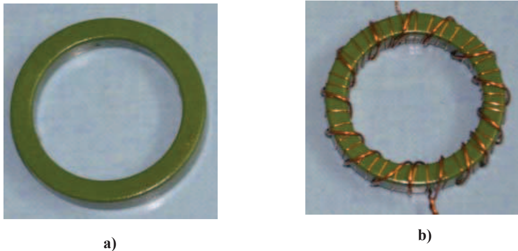
Figure 1.21. Présentation d'un circuit magnétique torique a) tore seul et b) tore avec bobinages
