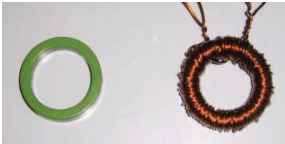
Figure 3.2.a. FeNi 80/20 avant (à gauche) et après bobinage (à droite) par le fil de cuivre haute température
