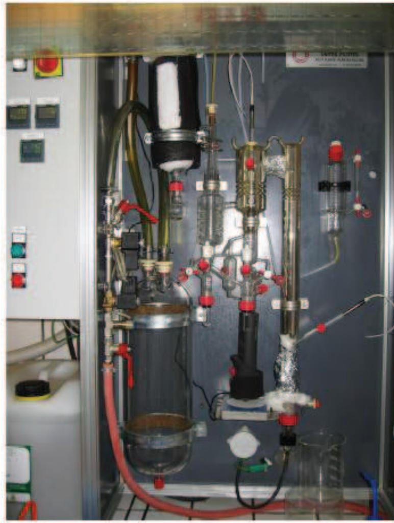
**Figure 4.18 :** Ebulliomètre utilisé au laboratoire.
