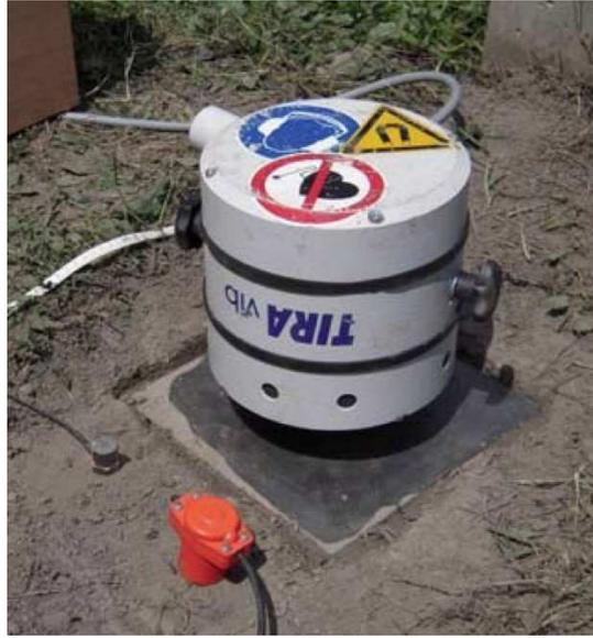
FIGURE 5.27 – Pot vibrant de l’IFSTTAR utilisé dans le cadre d’acquisitions de terrain, notamment sur le site test de Grenoble
