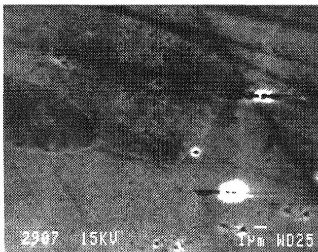
**figure 55 : Vue au MEB de la surface d'un dépôt de chrome réalisé à 30°C**
