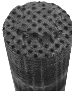
FIGURE 1.4 – Structure d'un matériau composite C/C d'un bouclier thermique [YZX + 08].
