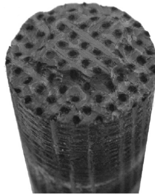
FIGURE 1.4 – Structure d'un matériau composite C/C d'un bouclier thermique [YZX + 08].
