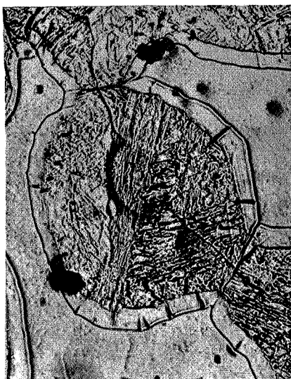
- c - Alliage Fe-Cr (Cr: 10,7%; C: 100 \cdot 10^{-4}\% ) trempé à l'air à partir de 1250^\circ\text{C} (G = 450).
