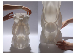
Fig. 21 A l'échelle de l'objet la production de surfaces continues à courbure variable est possible grâce aux machines à contrôle numérique. N. Oxman, Raycounting (2007)
