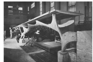
Fig. 14b S.Musmeci, maquette mécanique pour la recherche de forme ; pont sur le fleuve Basento, Italie (1977)
