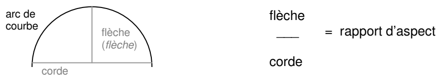
Fig.5 Dans la perception de la courbure bidimensionnelle, deux indices ont été identifiés comme significatifs par des expériences précédentes : la flèche (appelée aussi « flèche ») et le rapport entre corde et flèche (dénommé « rapport d'aspect »).
