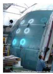
Fig. 23 La continuité conceptuelle est matérialisée dans la maquette à travers la résine de verre, qui peut être moulée dans une forme unitaire. A l'échelle réelle, la même continuité est impossible, il faut faire recours à un agencement complexe d'éléments discrets. P.cook et C.Fournier, Kunsthhaus, Graz, Autriche (2001)
