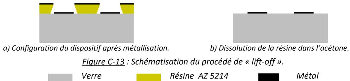
A la fin de cette étape, les électrodes de platine sont créées. Le procédé est à nouveau réalisé pour obtenir les électrodes d'argent. Après le dépôt de résine AZ 5214 sur le dispositif obtenu précédemment, l'insolation de la résine est réalisée sous le second masque (Figure C-14) qui permet d'obtenir quatre électrodes de 160  $\mu\text{m}$  de largeur. Afin de faire coïncider les deux niveaux, l'utilisation d'un aligneur est indispensable.
