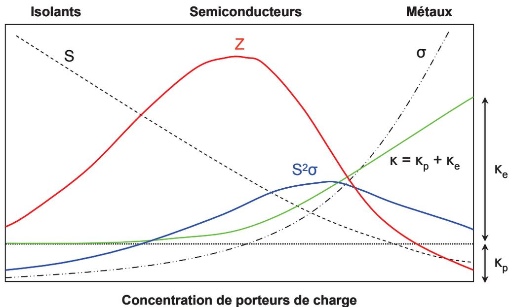
**Fig. 1.12.** Conductivité électrique  $\sigma$ , coefficient Seebeck  $S$ , conductivité thermique  $\kappa$ , facteur de puissance  $S^2\sigma$  et facteur de mérite  $Z$  en fonction de la concentration des porteurs de charge [4].
