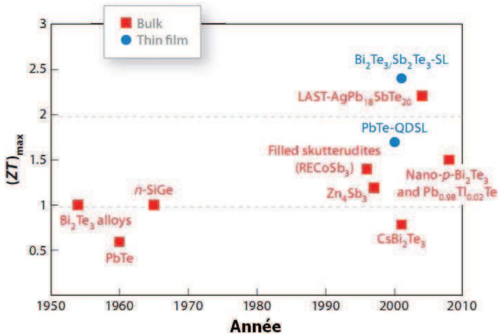
**Fig. 1.21.** Evolution du facteur de mérite des meilleurs matériaux thermoélectriques au cours du temps. Abréviations : LAST – composé de Pb-Ag-Sb-Te ; SL – super réseaux (*super lattices*) ; QDSL – super réseaux avec des boîtes quantiques incorporées (*quantum dot super lattices*) [18].
