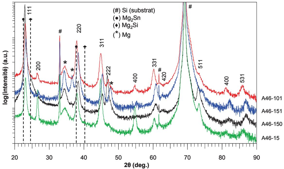
**Fig. 4.5.** Diagramme de diffraction de rayons X des couches minces de  $\text{Mg}_2\text{Si}_{0,4}\text{Sn}_{0,6}$  dopées Ag, déposées à différentes pressions et avec différentes puissances micro-onde.
