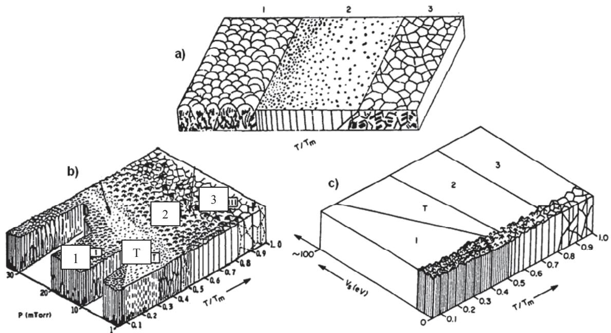
**Fig. 2.3.** Diagramme des zones de structure en fonction des paramètres de dépôt : (a) Movchan-Demchishin [4], (b) Thornton [5], et (c) Messier [7].
