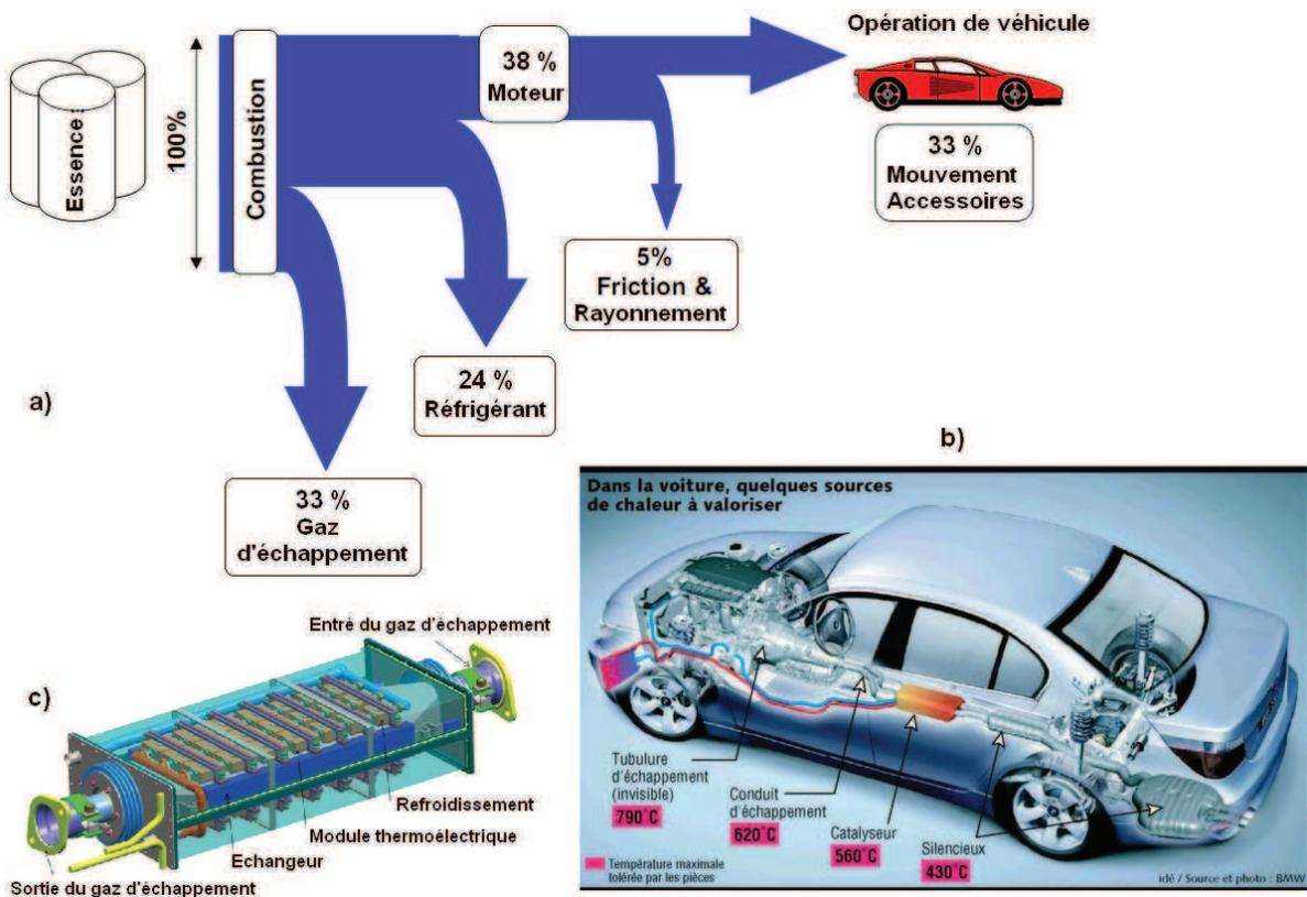
Fig. 1.8. Bilan énergétique d'un véhicule (a), sources de chaleur pour la récupération d'énergie (b), et schéma d'un générateur thermoélectrique intégré au catalyseur du véhicule (c) [12,15].
