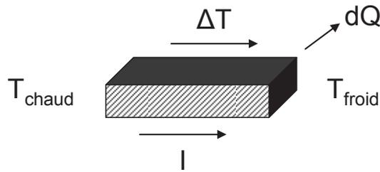
**Fig. 1.2.** Schéma de principe de l'effet Thomson.
