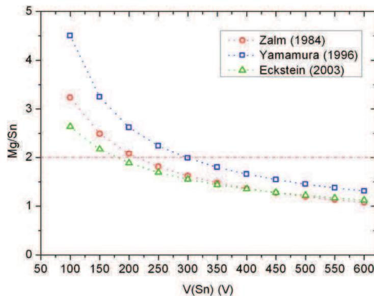
**Fig. 3.2.** Rapport des taux de pulvérisation  $S(\text{Mg})/S(\text{Sn}) = \text{Mg}/\text{Sn}$  en fonction du potentiel de polarisation des cibles Sn, pour un potentiel des cibles Mg fixé à 450 V.
