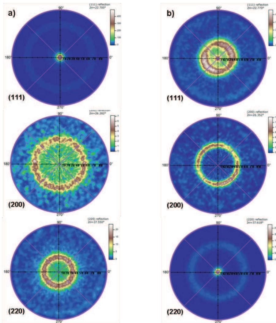
Fig. 3.8. Figures de pôles des couches Mg<sub>2</sub>Sn(Ag) pour  $V_{\text{Sn(Ag)}} = 200$  V (a) et 215 V (b) (*Série 1*).
