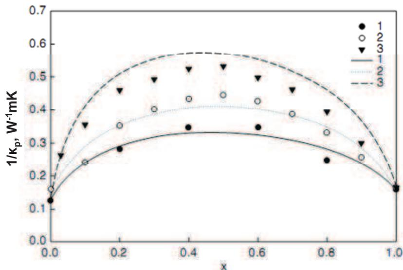
**Fig. 1.29.** Evolution de la résistivité thermique des phonons (à température ambiante) en fonction de la composition des solutions solides : (1)  $Mg_2Si_{1-x}Ge_x$  ; (2)  $Mg_2Sn_{1-x}Ge_x$  ; (3)  $Mg_2Si_{1-x}Sn_x$  [36].
