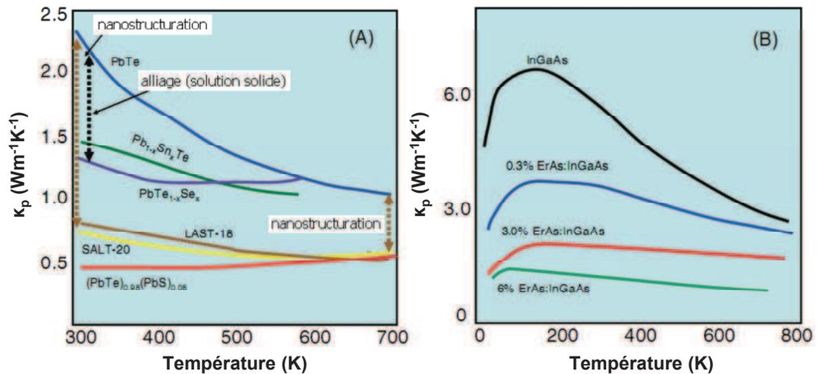
**Fig. 1.20.** Conductivité thermique (composante  $\kappa_p$ ) en fonction de la température pour :
