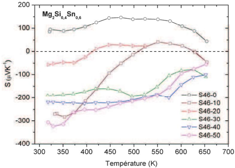
**Fig. 4. 18.** Coefficient Seebeck en fonction de la température pour des couches minces  $\text{Mg}_2\text{Si}_{0.4}\text{Sn}_{0.6}$  à différentes tensions de polarisation de la cible de dopage Sb.
