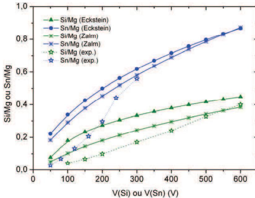
**Fig. 4.2.** Rapport atomique Si/Mg et Sn/Mg en fonction du potentiel de polarisation des cibles Si, Sn pour un potentiel de polarisation des cibles Mg fixée à 500 V. Comparaison entre calcul et expérience.
