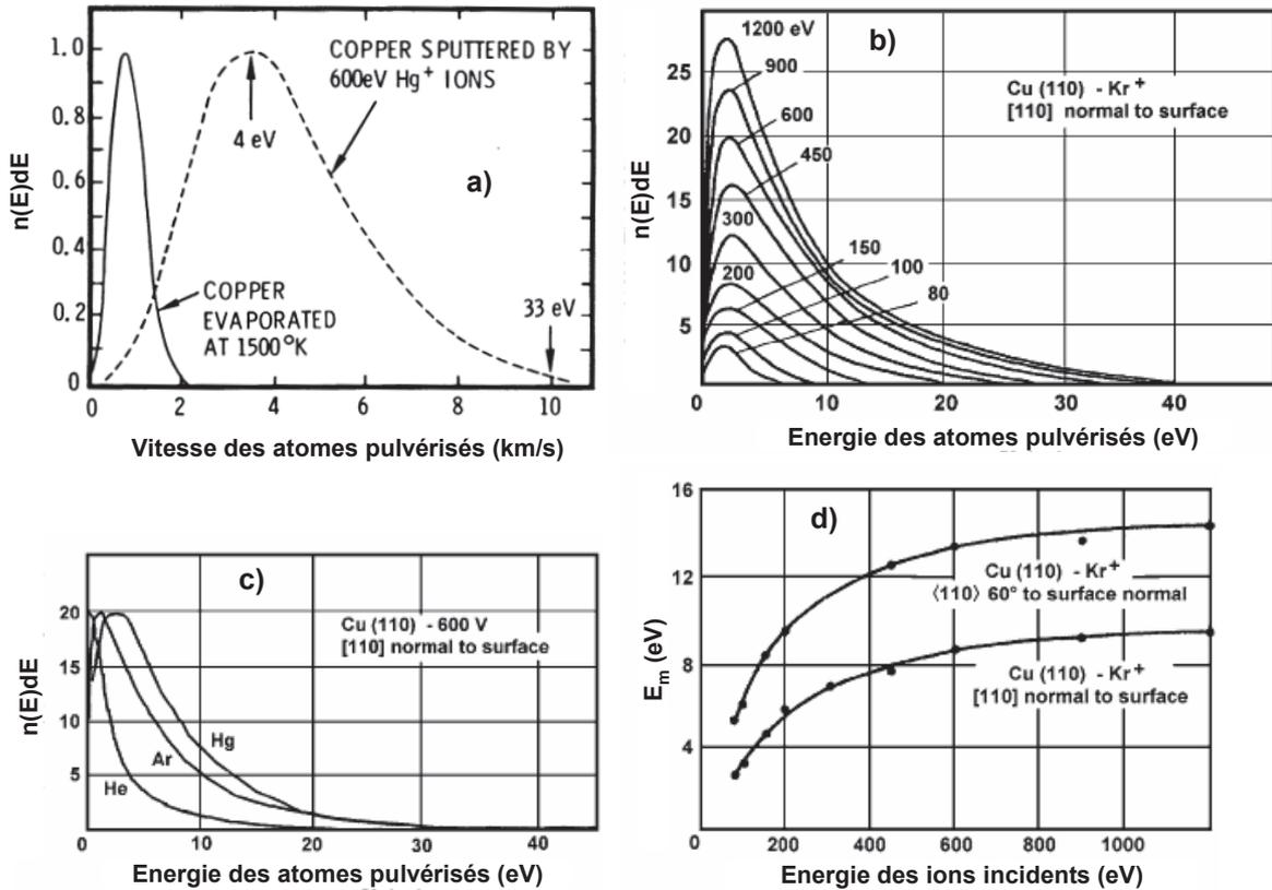
**Fig. 2.6.** Distribution en énergie des atomes de cuivre pulvérisés par : a)  $Hg^+$  de 600 eV (ligne en pointillée) et évaporation à 1500 K (ligne continue), b)  $Kr^+$  à différentes énergies, c)  $He^+$ ,  $Ar^+$ ,  $Hg^+$  à 600 eV, et d)  $Kr^+$  pour deux angles d'incidence [1,2,36].
