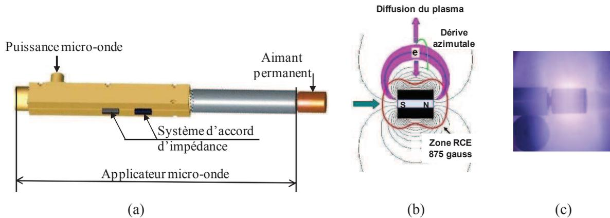
**Fig. 2.9.** Schéma d'une source plasma élémentaire (a), zone de couplage RCE et production du plasma par diffusion (b), et image d'un plasma (c).
