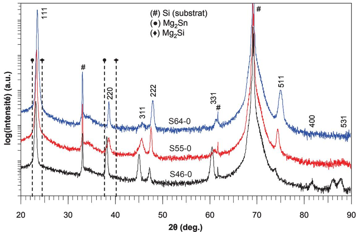
**Fig. 4.12.** Comparaison des diffractogrammes X des couches minces :  $\text{Mg}_2\text{Si}_{0,4}\text{Sn}_{0,6}$  (S46-0),  $\text{Mg}_2\text{Si}_{0,5}\text{Sn}_{0,5}$  (S55-0) et  $\text{Mg}_2\text{Si}_{0,6}\text{Sn}_{0,4}$  (S64-0).
