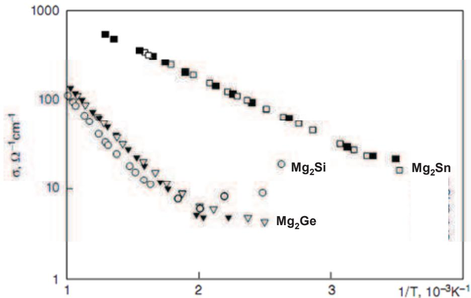
**Fig. 1.24.** Conductivité électrique des composés  $\text{Mg}_2\text{B}^{\text{IV}}$  en fonction de l'inverse de la température ; symboles pleins les matériaux du type n, et symboles vides ceux type p [36].
