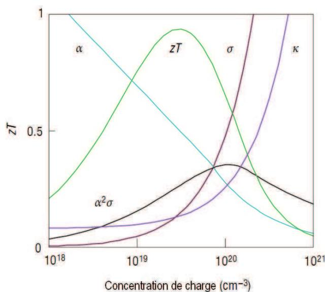
**Fig. 1.14.** Facteur de mérite  $ZT$  en fonction de la concentration de charge pour l'alliage  $\text{Bi}_2\text{Te}_3$  [27].
