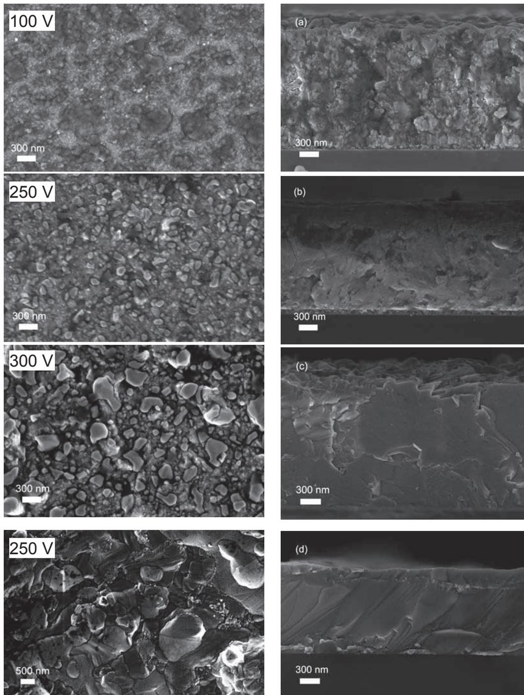
**Fig. 3.9.** Morphologie de surface (gauche) et de section (droite) des couches  $Mg_2Sn(Ag)$  pour différents potentiels  $V_{Sn(Ag)}$  à :  $h = 120$  mm (a–c), et  $h = 200$  mm (d).
