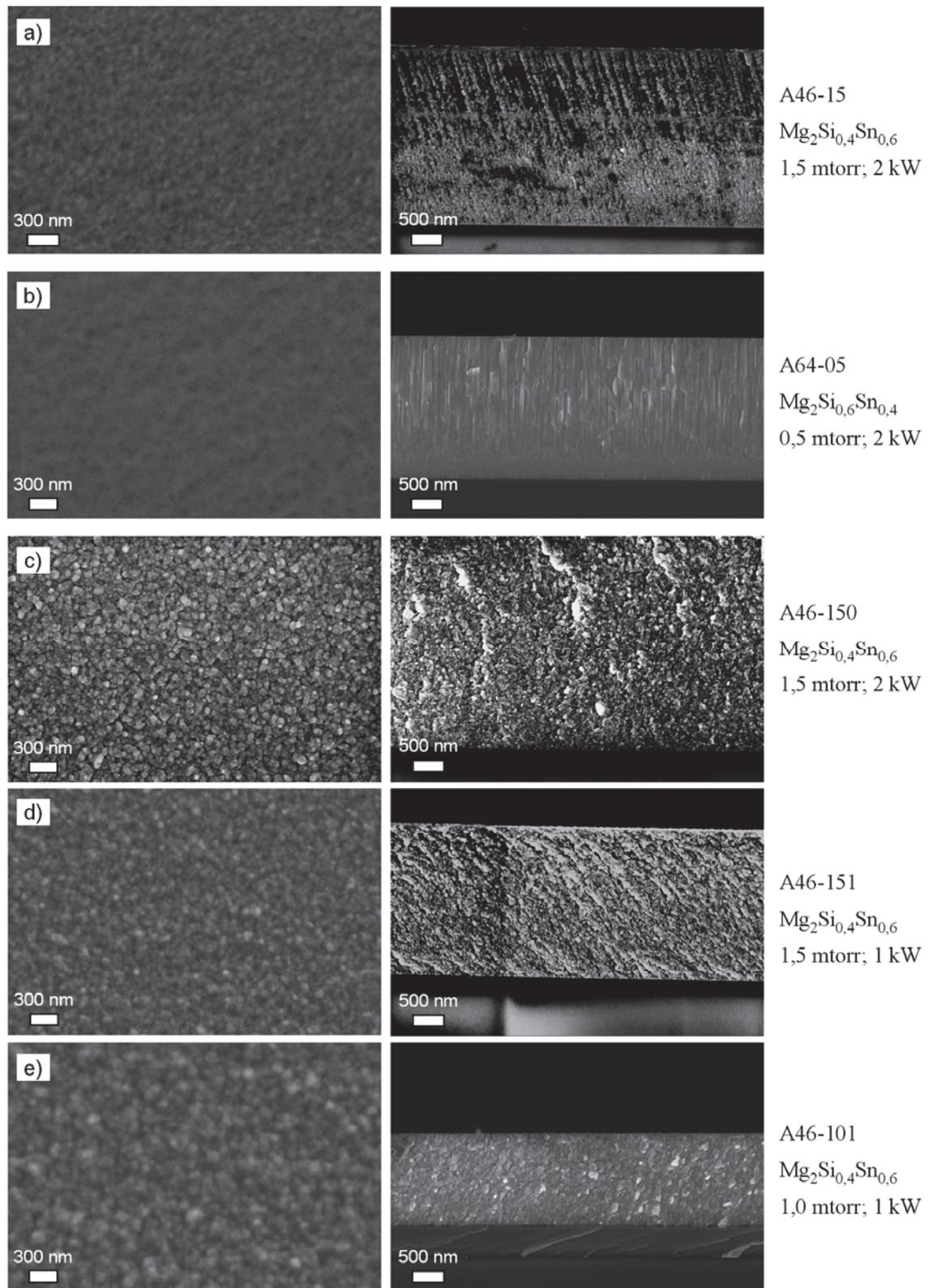
**Fig. 4.6.** Morphologie de surface (à gauche) et de section (à droite) des couches minces  $\text{Mg}_2\text{Si}_{1-x}\text{Sn}_x$  ( $x = 0,4 ; 0,5$  et  $0,6$ ) dopées Ag, déposées à différentes conditions de dépôt.
