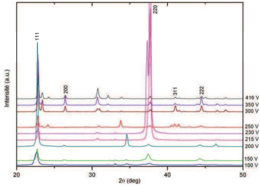
Fig. 3.7. Diffractogrammes X des couches Mg<sub>2</sub>Sn (*Série 1* :  $h = 120$  mm).
