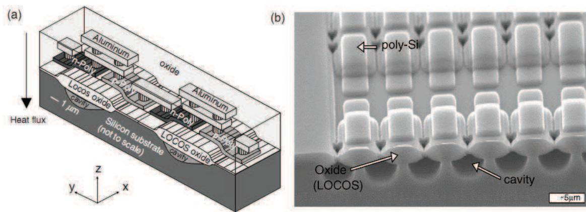
**Fig. 1.32.** Micromodules thermoélectriques en couches minces pour des applications de refroidissement : (a) vue générale et (b) en section transversale. (module fabriqué par la technologie CMOS par la société Infineon, Allemagne) [105].
