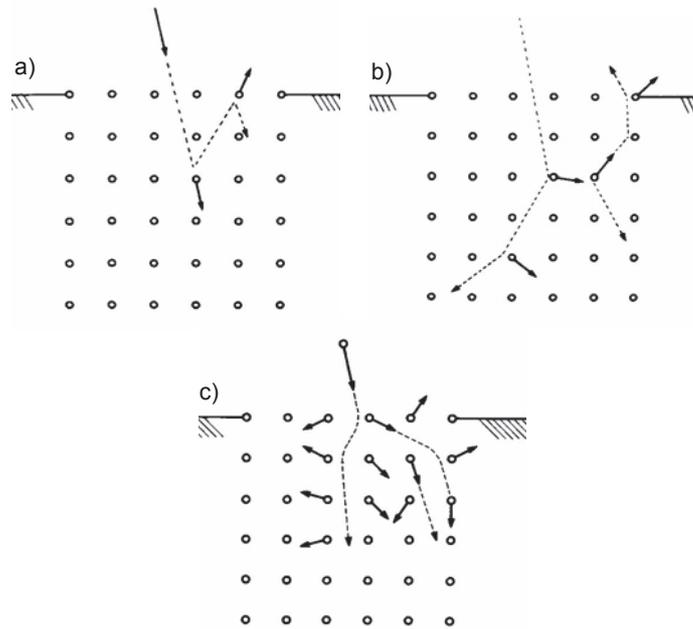
**Fig. 2.4.** Régimes de pulvérisation en fonction de l'énergie des ions incidents : a) simple choc ( $\sim 40 \text{ eV} < E < \sim \text{keV}$ ) ; b) collisions en cascade linéaire ( $\sim \text{keV} < E < \sim \text{MeV}$ ) ; c) collisions en cascade non-linéaire ( $E > \text{MeV}$ ) [14].
