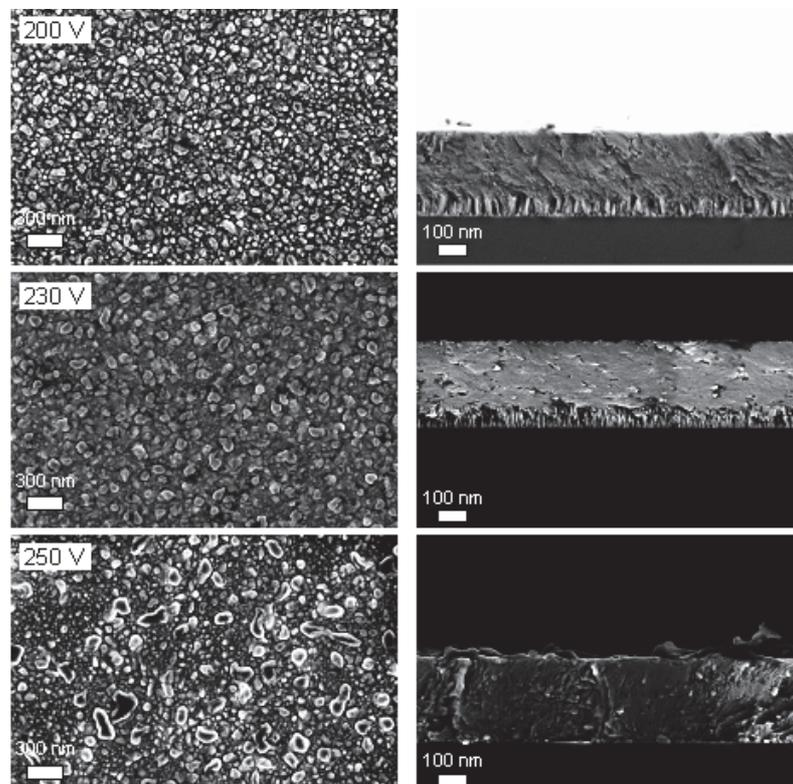
**Fig. 3.15.** Morphologie de surface (gauche) et de section (droite) des couches  $\text{Mg}_2\text{Sn}$  (Sb) pour différents potentiels  $V_{\text{Sn(Ag)}}$  (*Série 2* :  $h = 200$  nm, substrat Si(100)).
