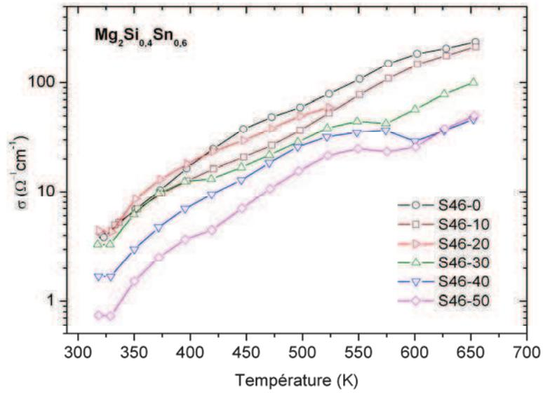
**Fig. 4.17.** Conductivité électrique en fonction de la température pour des couches minces  $\text{Mg}_2\text{Si}_{0.4}\text{Sn}_{0.6}$  à différentes tensions de polarisation de la cible de dopage Sb.
