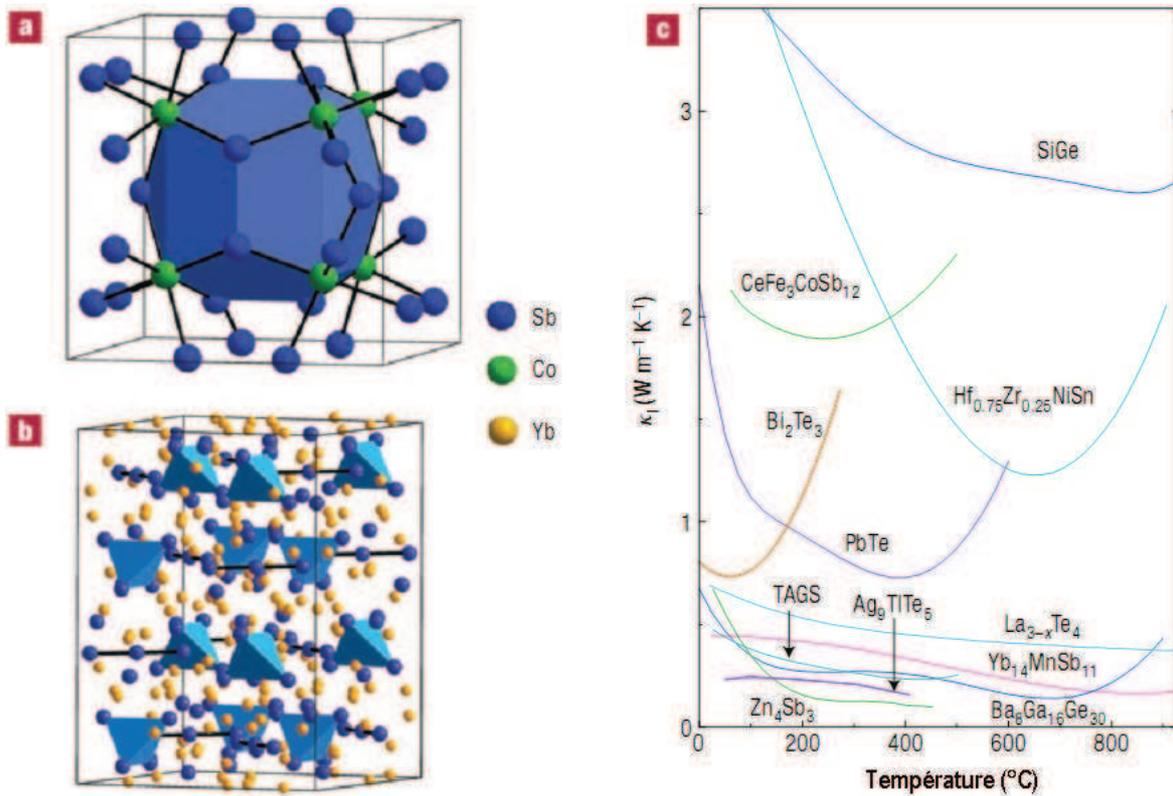
**Fig. 1.16.** Matériaux thermoélectriques de structure complexe : (a) skutterudite (ici CoSb<sub>3</sub>) avec des grandes cages (polygones, au milieu en bleu) ; (b) Zintl Yb<sub>14</sub>MnSb<sub>11</sub> ; (c) Conductivité thermique pour différentes structures cristallines complexes [27].
