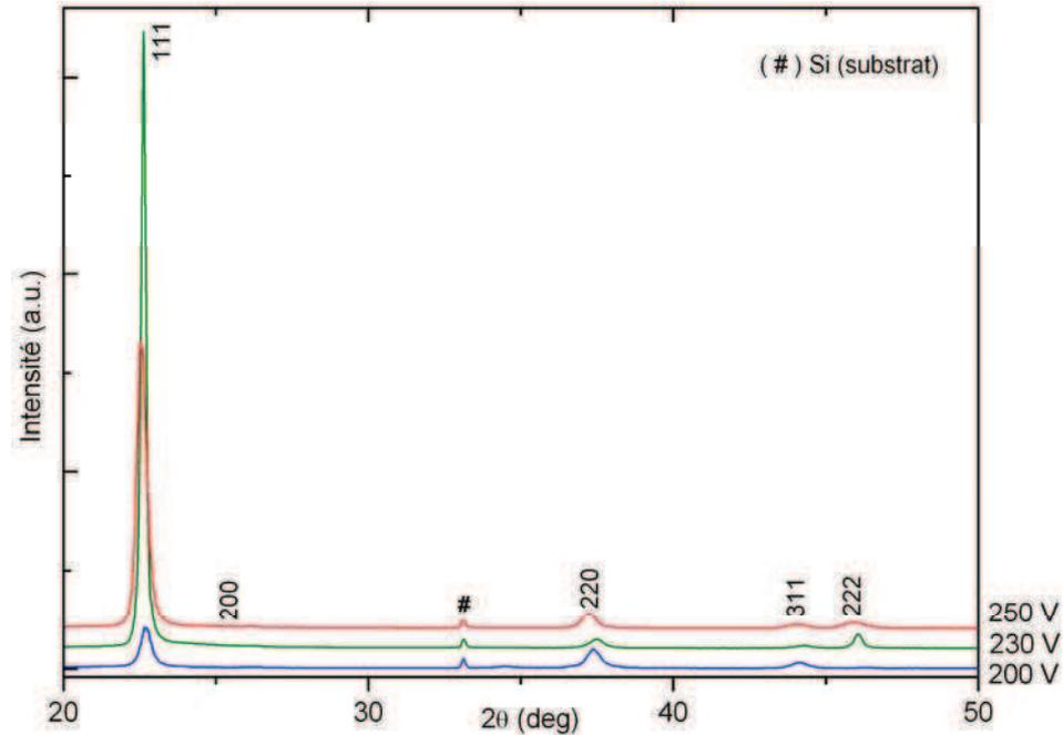
**Fig. 3.12.** Agrandissement de diffractogrammes X des couches  $Mg_2Sn(Sb)$  pour différents potentiels  $V_{Sn(Sb)}$  de polarisation des cibles Sn,  $V_{Mg} = 450$  V (*Série 1* :  $h = 120$  mm, substrat Si(100)).
