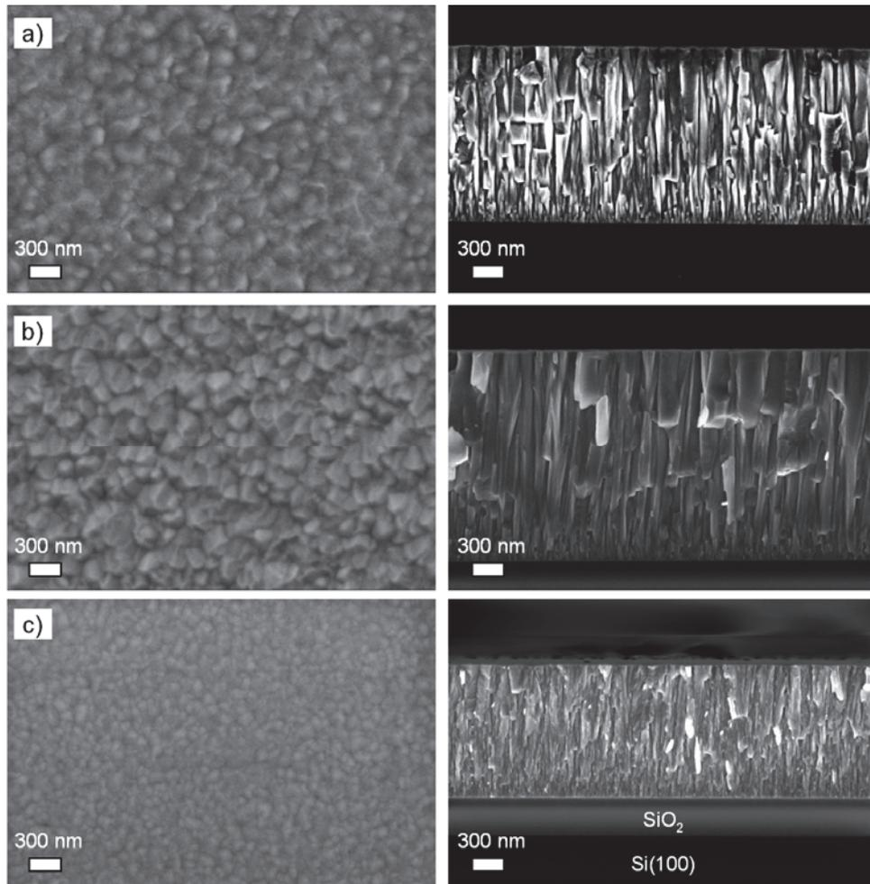
**Fig. 4.13.** Morphologie typique de surface (à gauche) et de section (à droite) des couches minces :
