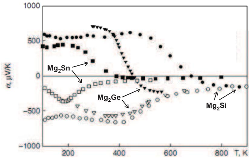
**Fig. 1.25.** Coefficient Seebeck des composés  $\text{Mg}_2\text{B}^{\text{IV}}$  en fonction de la température [36].
