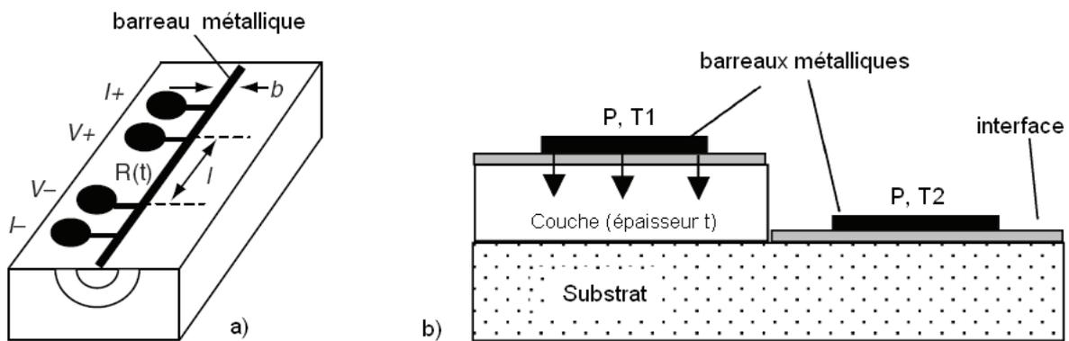
**Fig. 2.16.** Schéma de principe de la méthode  $3\omega$  pour mesurer la conductivité thermique : (a) des matériaux massifs ou en couches minces  $t > 10 \mu\text{m}$  et (b) des couches minces  $t < 10 \mu\text{m}$  [56].
