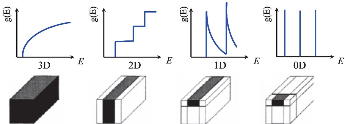
**Fig. 1.18.** Densité d'états électroniques  $g(E)$  en fonction de l'énergie électronique pour différentes dimensions du matériau : 3D – matériaux massifs, 2D – puits quantiques, 1D – nano fils ou nano tubes, et 0D – boîtes quantiques [30].
