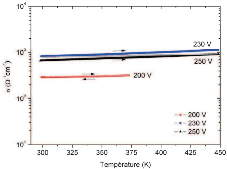
**Fig. 3.17.** Conductivité électrique des couches  $\text{Mg}_2\text{Sn}(\text{Sb})$  en fonction de la température, pour différents potentiels  $V_{\text{Sn}(\text{Sb})}$  de polarisation,  $V_{\text{Mg}} = 450 \text{ V}$  (Série 2 :  $h = 200 \text{ mm}$ ).
