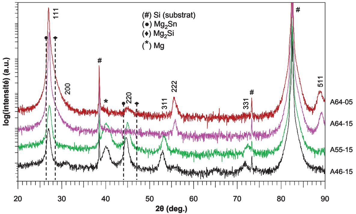
**Fig. 4.4.** Diagrammes de diffraction de rayons X (anticathode Co) des couches minces dopées Ag :  $\text{Mg}_2\text{Si}_{0,4}\text{Sn}_{0,6}$ ,  $\text{Mg}_2\text{Si}_{0,5}\text{Sn}_{0,5}$  et  $\text{Mg}_2\text{Si}_{0,6}\text{Sn}_{0,4}$  ( $p = 1,5$  ou  $0,5$  mtorr,  $P = 2$  kW).
