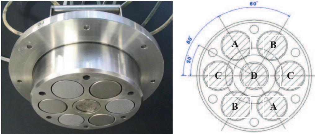
**Fig. 2.13.** Positionnement des cibles sur le porte-cibles.
