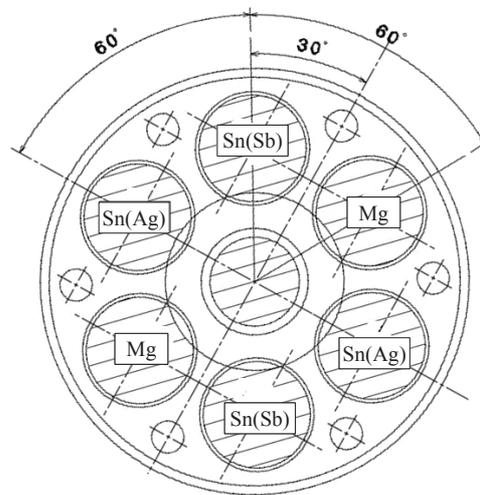
**Fig. 3.1.** Positionnement des cibles sur le porte-cibles.
