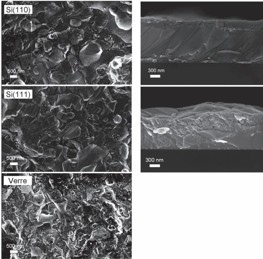
**Fig. 3.10.** Morphologie de surface (gauche) et transversale (droite) des couches minces pour trois types de substrats (Série 2 :  $h = 200$  mm,  $V_{\text{Sn(Ag)}} = 250$  V,  $V_{\text{Mg}} = 450$  V).
