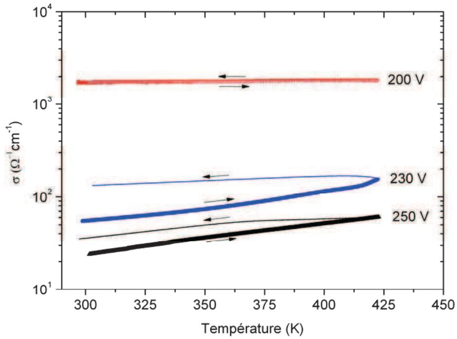
**Fig. 3.16.** Conductivité électrique des couches  $\text{Mg}_2\text{Sn}(\text{Sb})$  en fonction de la température, pour différents potentiels  $V_{\text{Sn}(\text{Sb})}$  de polarisation,  $V_{\text{Mg}} = 450 \text{ V}$  (Série 1 :  $h = 120 \text{ mm}$ ).
