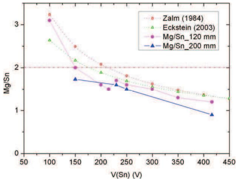
**Fig. 3.3.** Composition de couches minces  $Mg_2Sn(Ag)$  en fonction du potentiel de polarisation négative des cibles Sn, pour deux distances  $h = 120$  et  $200$  mm ( $V_{Mg} = 450$  V).
