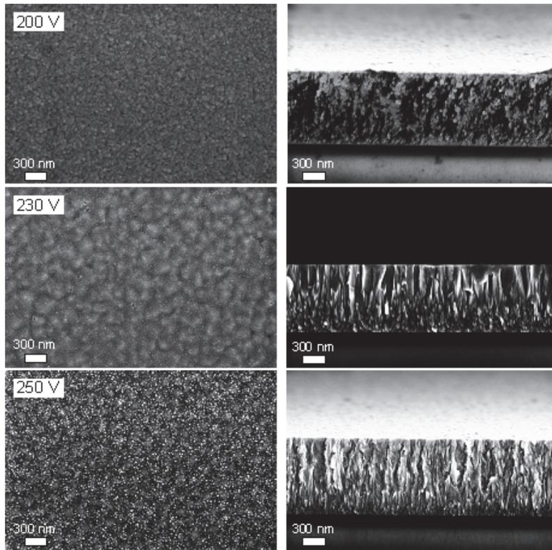
**Fig. 3.14.** Morphologie de surface (gauche) et de section (droite) des couches  $\text{Mg}_2\text{Sn}$  (Sb) pour différents potentiels  $V_{\text{Sn(Ag)}}$  (*Série 1* :  $h = 120$  nm, substrat Si(100)).
