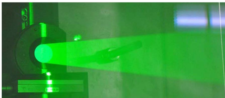
Figure 39 : Photographie du miroir placé dans la cuve de BERGAME, réfléchissant la nappe laser
