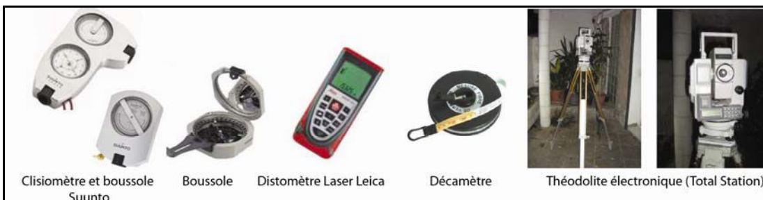
Figure 3.1. Les différents outils utilisés pour un levé topographique de terrain.
