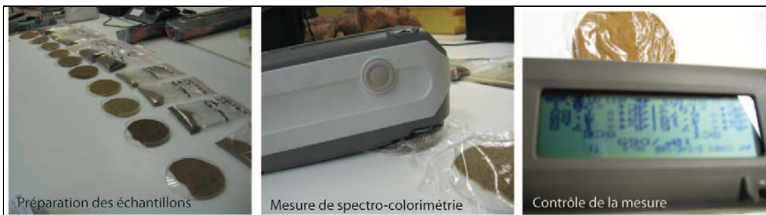
Figure 3.15. La préparation des échantillons et les mesures de spectrophotométrie avec le Minolta CM 2600 TM .
