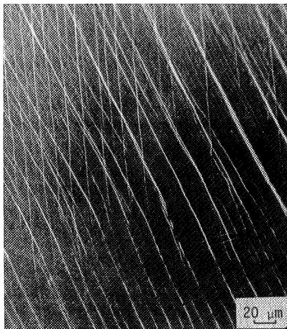
b - Lignes de glissement dans un joint, témoignant de la déformation plastique des grains avant rupture.
