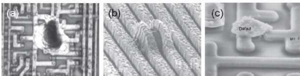
Figure 1.6 : Exemples d'effets néfastes liés à la présence de particules lors de la production de circuits imprimés (a) Particule prise dans un dépôt métallique. (b) Gêne stérique provoquée par une particule (c) Particule posée sur le composant en position de court circuit [10]
