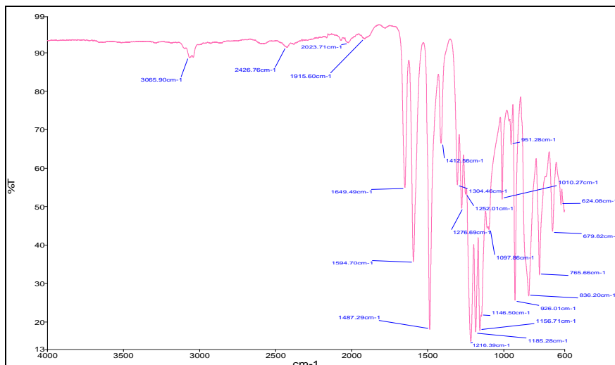
Spectre ATR du film PEEK d'épaisseur 0,25mm
