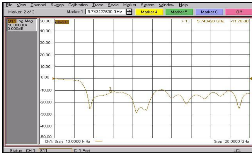
Figure II.19. Coefficient de réflexion mesuré de l'antenne ULB optimisée par algorithme génétique
