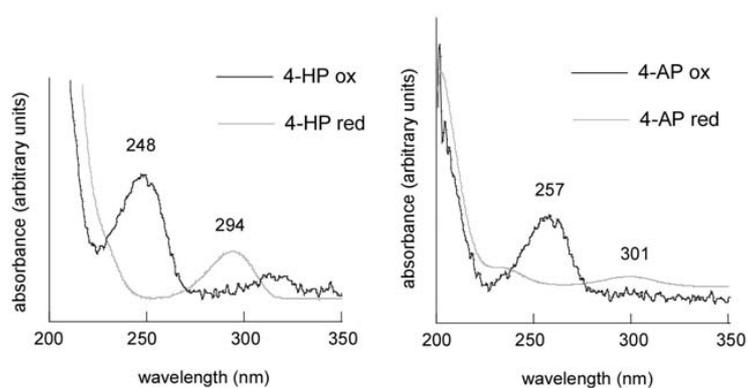
**Figure 26:** Spectres UV-visible du 4-AP et du 4-HP purifiés sous les formes oxydées et réduites. Les produits purifiés ont été injectés sur la colonne de HPLC avec un potentiel de l'électrode de la précolonne fixé à +550 mV (ox) ou -500mV (red).
