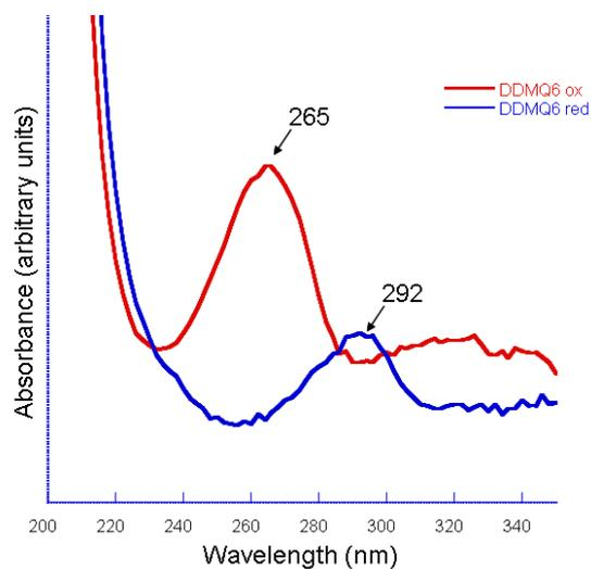
**Figure 47:** Spectre UV-visible de la DDMQ<sub>6</sub> purifiée sous les formes oxydées et réduites. La DDMQ<sub>6</sub> purifiée a été injectée sur la colonne de HPLC avec un potentiel de l'électrode de précolonne fixée à +550 mV (ox) et -550 mV (red).
