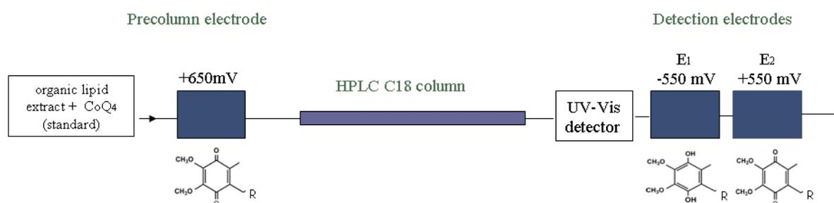
**Figure 18:** Schéma représentatif du système HPLC-ECD utilisé.
