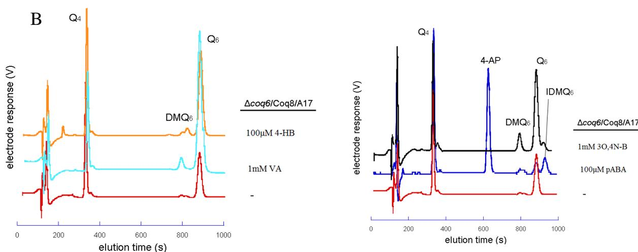
**Figure 76:** Synthèse de coenzyme  $Q_6$  dans  $\Delta coq6/Coq8/A2$  et  $\Delta coq6/Coq8/A17$  en présence du 3O,4N-B. Les cellules  $\Delta coq6/Coq8/A2$  (A),  $\Delta coq6/Coq8/A17$  (B) ont été cultivées en YNB-P 2% glucose contenant ou non les concentrations indiquées de pABA, 4-HB, VA ou 3O,4N-B. Les extraits lipidiques de 4 mg de cellules ont été analysés par HPLC-ECD.
