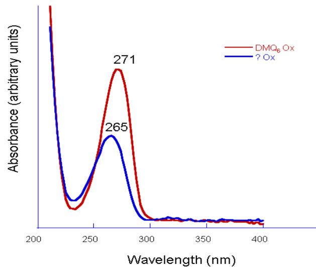
**Figure 59:** Spectre UV-visible de la DMQ<sub>6</sub> et du nouveau composé accumulé (?) en présence de 2,4-diHB dans  $\Delta coq7/Coq8$  sous la forme oxydée. Les produits ont été injectés sur la colonne HPLC avec un potentiel de l'électrode de la précolonne fixé à +550 mV (ox).
