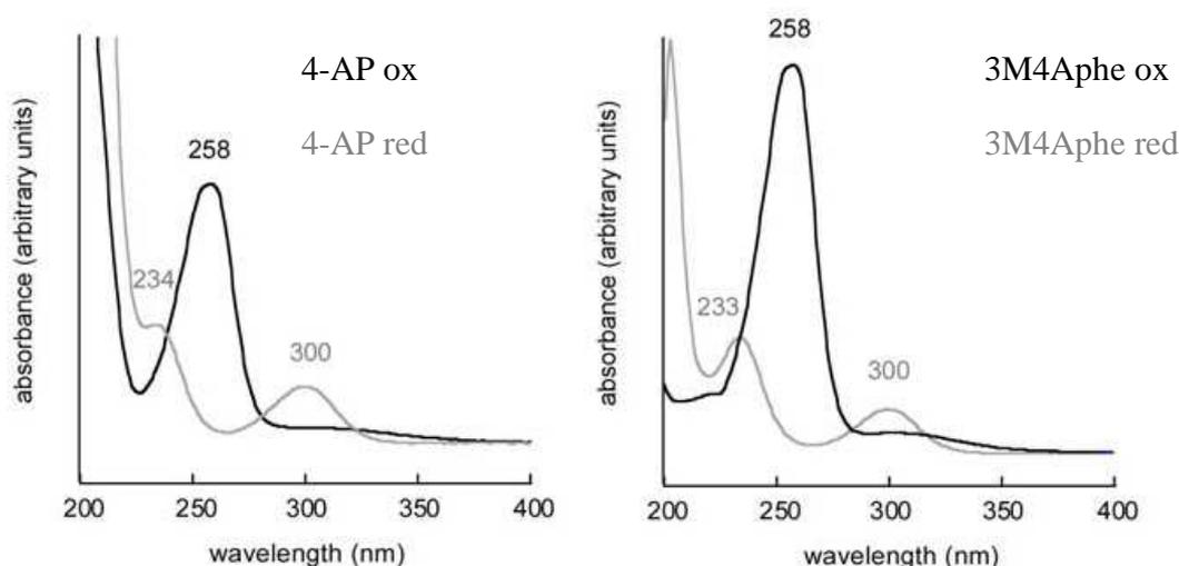
**Figure 21:** Comparaison des spectres UV-visible du 4-AP et du produit commercial (3M4Aphe). Une quantité égale du 3H4Aphe et du 4-AP a été injectée sur la colonne de HPLC avec un potentiel de l'électrode de précolonne fixé à +550 mV (ox) ou -500mV (red). Les spectres UV-visible des formes oxydées (ox) et réduites (red) de 3H4Aphe et 4-AP ont été enregistrées et les maxima d'absorption sont indiqués.
