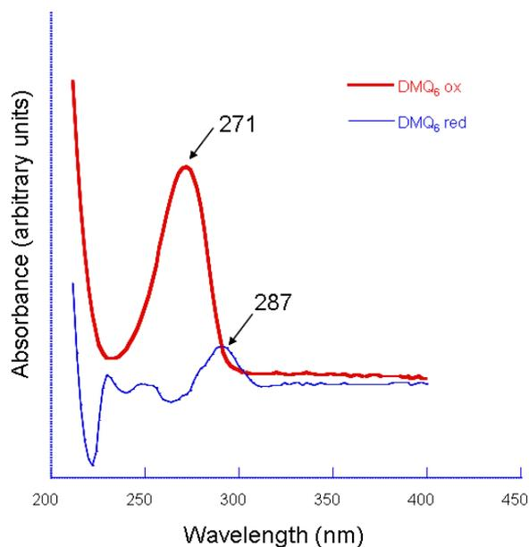
**Figure 45:** Spectre UV-visible de la  $DMQ_6$  purifiée sous les formes oxydées et réduites. Les produits purifiés ont été injectés sur la colonne de HPLC avec un potentiel de l'électrode de la précolonne fixée à +550 mV (ox) et -550 mV (red).
