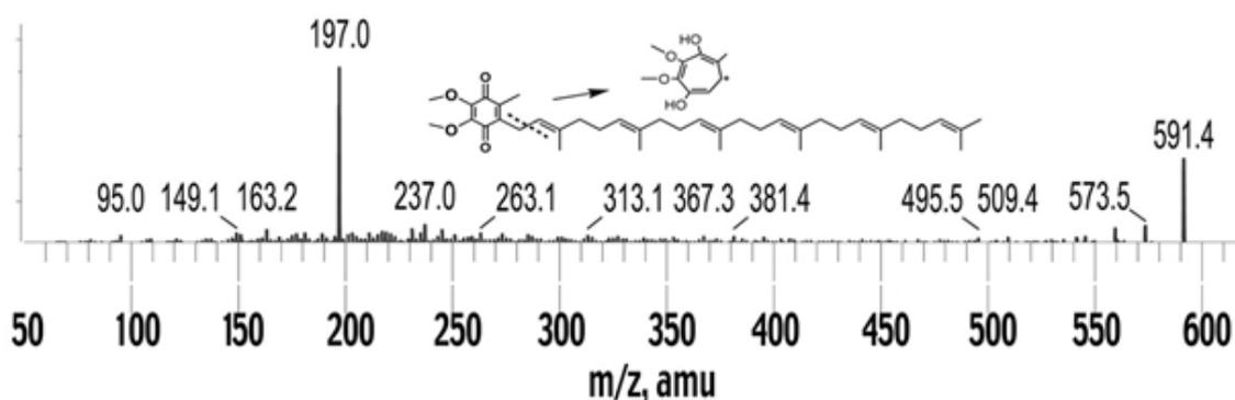
**Figure 19:** Spectre de masse de fragmentation du coenzyme  $Q_6$ . La structure de  $Q_6$  ainsi que la rupture de liaison (en pointillé) qui conduit à la formation de l'ion tropylium à  $m/z=197$  sont indiquées. La masse moléculaire ionique  $[M+H]^+$  du coenzyme  $Q_6$  ( $C_{39}H_{58}O_4^+$ ) est de 591,4 et celle de l'ion tropylium  $[M]^+$  ( $C_{10}H_{13}O_4^+$ ) est de 197,0.
