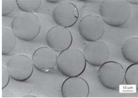
FIGURE 2.3: Décohésion fibre/matrice [Sjörögen et Berglung (2000)].
