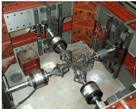
Figure 2.2. Dispositif d'essais biaxiaux Smits et al., 2006
